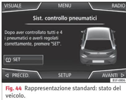
Fig. 44 Rappresentazione standard: stato del veicolo.
