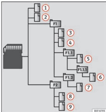
**Fig. 13** Possibile struttura di un supporto elettronico audio.
