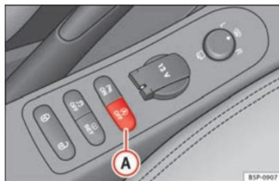
Fig. 137 The Start-Stop function button.
