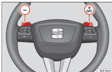
Fig. 129 Volante con leve per il cambio automatico.
