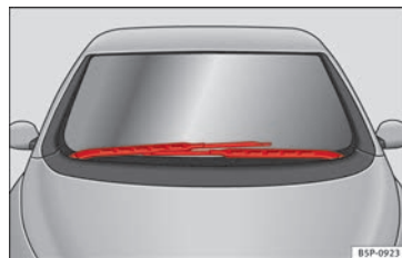
Fig. 169 Tergicristallo in posizione di manutenzione.
