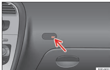
Fig. 20 Spia della disattivazione degli airbag del passeggero anteriore.
