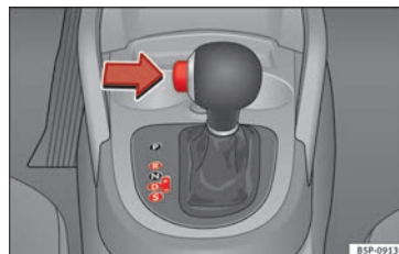
Fig. 127 Console centrale: leva selettice del cambio automatico.
