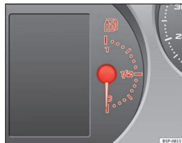
Fig. 28 Quadro strumenti: Indicatore del livello del GPL
