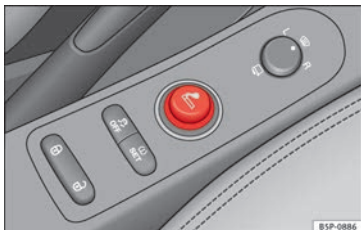
Fig. 96 Accendisigari all'interno della presa di corrente della console centrale anteriore.
