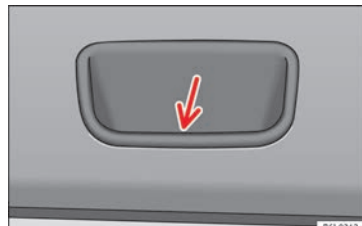
Fig. 54 Dettaglio del rivestimento interno del portellone posteriore: maniglia di presa ad incavo.
