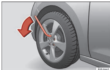
Fig. 157 Cambio di una ruota: allentare le viti della ruota.
