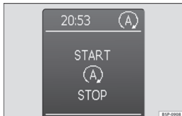
Fig. 133 Indicazione nel display del quadro strumenti durante la modalità Start-Stop.
