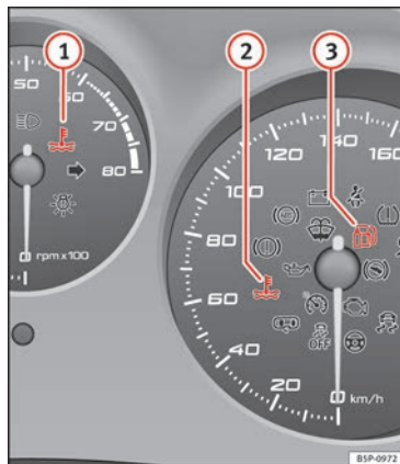
Fig. 31 Spie nel quadro strumenti per veicoli con GPL.
