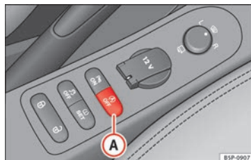
Fig. 132 Dettaglio del pulsante della modalità Start-Stop.
