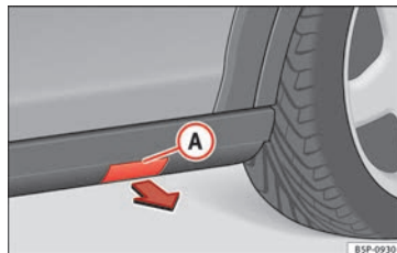
Fig. 160 Sottoporta in plastica con sede per fissaggio del cric.
