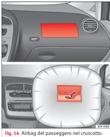
Fig. 14 Airbag del passeggero nel cruscotto.
