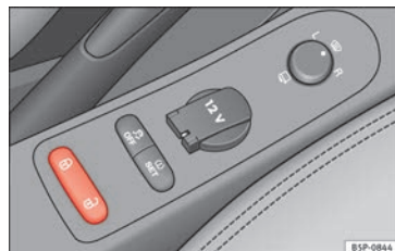
Fig. 47 Dettaglio della console centrale: tasto della chiusura centralizzata.
