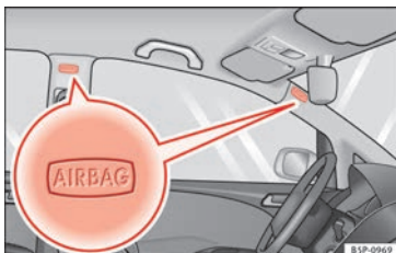
Fig. 17 Ubicazione degli airbag per la testa, lato sinistro del veicolo.
