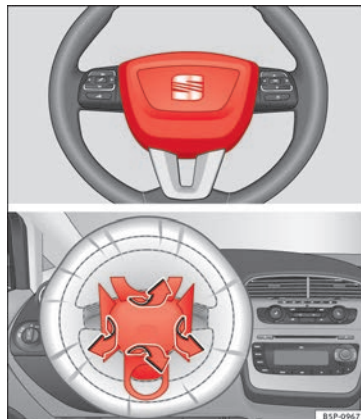
Fig. 13 Airbag del conducente nel volante.
