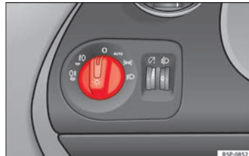
Fig. 58 Dettaglio della plancia portastrumenti: interruttore luci, fari fendinebbia e retronebbia.
