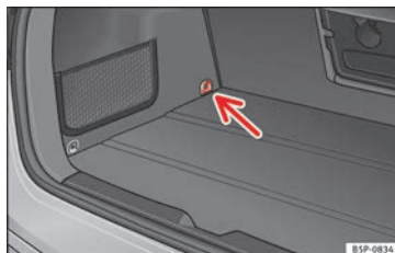
Fig. 24 Occhiello di fissaggio del sistema Top Tether*.
