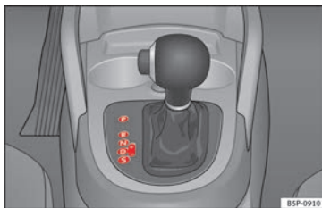
Fig. 125 Consolle centrale: leva del cambio automatico/cambio automatico DSG.
