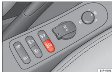
Fig. 121 Consolle centrale: tasto di commutazione dell'impianto a gas.
