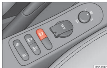
Fig. 134 Console centrale: Interruttore del sistema di assistenza per il parcheggio.
