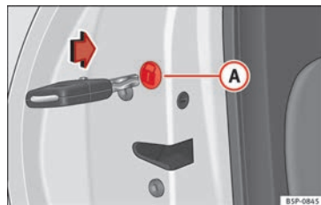
Fig. 167 Chiusura di emergenza delle porte.
