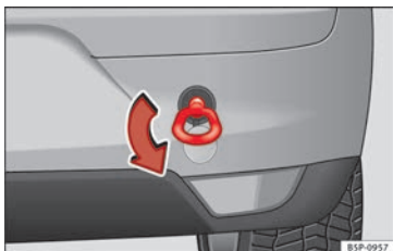
Fig. 166 Lato posteriore del veicolo: montaggio dell'occhiello di traino.
