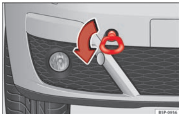
Fig. 165 Lato anteriore destro del veicolo: montaggio dell'occhiello di traino anteriore.
