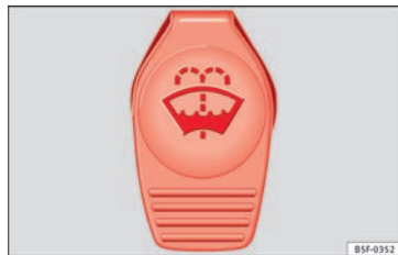
Fig. 150 Vano motore: tappo del serbatoio del liquido lavacrystalli
