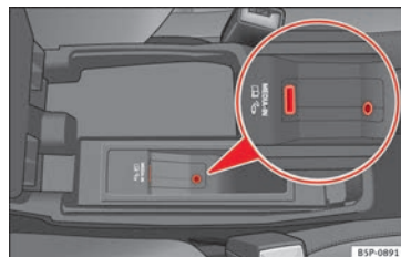
Fig. 101 Collegamento nel bracciolo centrale.
