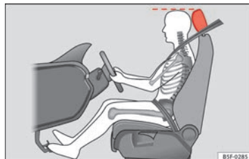
Fig. 2 Corretto posizionamento del poggiatesta del conducente.
