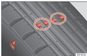
Fig. 152 Indicatori di usura del battistrada.
