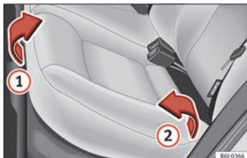
Fig. 153 Sollevamento dell'elemento orizzontale del sedile posteriore.
