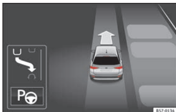
Fig. 211 Sul display del quadro strumenti: visualizzazione dell'assistente di parcheggio con visualizzazione ridotta.
