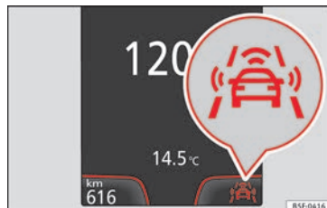
Fig. 189 Sul display del quadro strumenti: indicazione di Front Assist disattivato.
