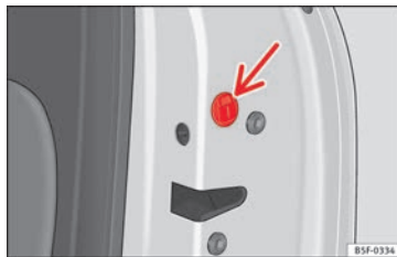
Fig. 5 Blocco di emergenza della porta.
