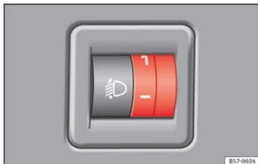
Fig. 146 Plancia portastrumenti: Correttore assetto fari
