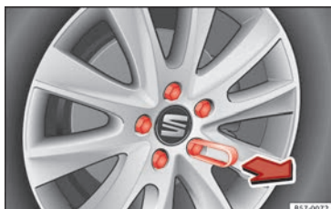
Fig. 79 Ruota: viti della ruota con tappi.
