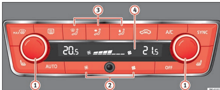
Fig. 60 Sulla consola centrale: comandi del Climatronic.
