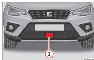
Fig. 188 Sul paraurti anteriore: sensore radar.
