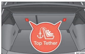
Fig. 31 Posizione degli occhielli Top Tether nella parte posteriore del sedile posteriore.
