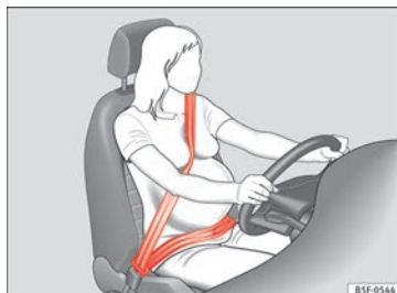
Fig. 101 Posizione del nastro della cintura di sicurezza per donne in stato di gravidanza.
