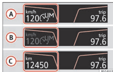
Fig. 184 Sul display del quadro strumenti: indicazioni dello stato del limitatore di velocità.
