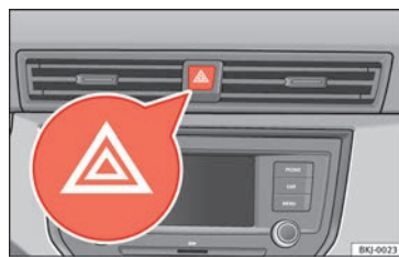
Fig. 39 Plancia portastrumenti: interruttore lampeggio di emergenza.
