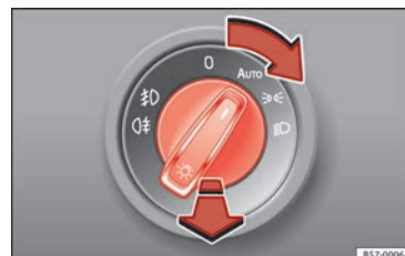
Fig. 37 Plancia portastrumenti: interruttore delle luci.
