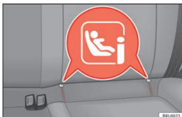
Fig. 30 Occhielli di fissaggio del sistema ISO-FIX/iSize.
