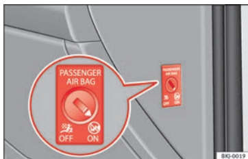
Fig. 102 Interruttore a chiave per l'attivazione e la disattivazione dell'airbag del passeggero.
