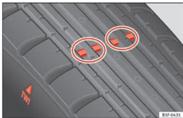
Fig. 239 Indicatori di usura del battistrada.
