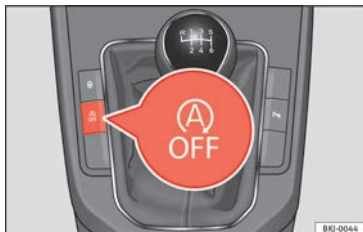
Fig. 182 Console centrale: tasto del sistema Start/Stop.
