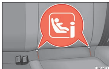
Fig. 32 Occhielli di fissaggio del sistema ISO-FIX/iSize.
