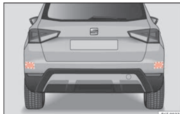
Fig. 202 Vista complessiva posteriore del veicolo: zone dei sensori radar.
