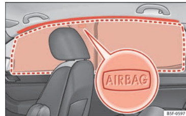
Fig. 25 Posizione e campo d'azione dell'airbag per la testa.
