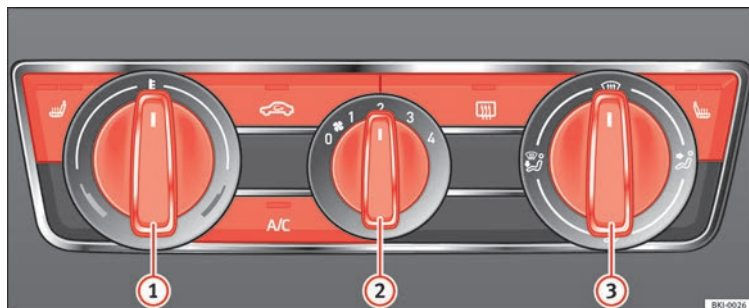
Fig. 171 Sul cruscotto: i comandi dell'aria condizionata.
