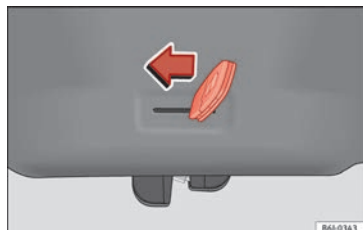
Fig. 7 Apertura d'emergenza del portellone posteriore.
