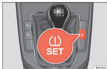
Fig. 241 Console centrale: tasto del sistema di controllo degli pneumatici.
