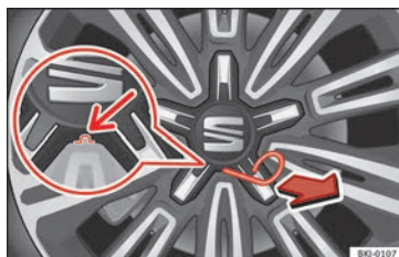
Fig. 77 Smontare il copricerchio centrale.
