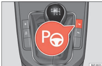
Fig. 209 Sulla console centrale: tasto per inserire l'assistente di parcheggio
