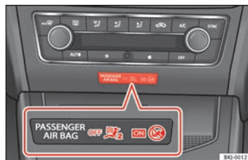
Fig. 55 Spia per la disattivazione dell'airbag del passeggero.
