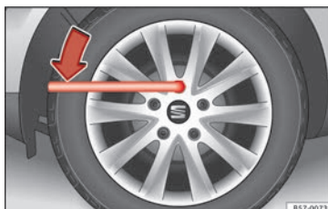
Fig. 80 Cambio di una ruota: allentare le viti della ruota.
