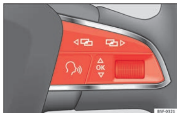
Fig. 45 Lato destro del volante multifunzionale: tasti di controllo.
