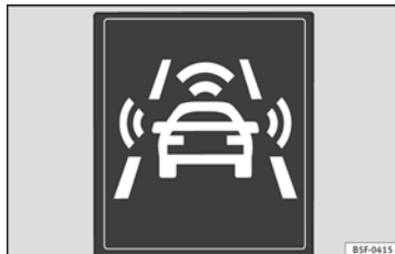
Fig. 190 Sul display del quadro strumenti: indicazione di preavvertimento.
