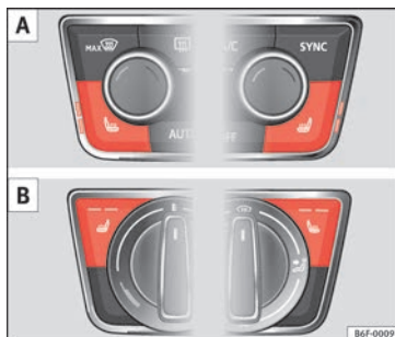
Fig. 152 Sulla console centrale: regolatore per il riscaldamento dei sedili anteriori. A : versione con Climatronic. B : versione con climatizzatore manuale.
