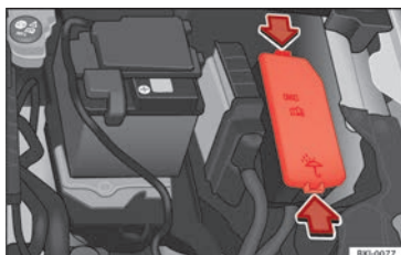
Fig. 70 Nel vano motore: coperchio della scatola dei fusibili.
