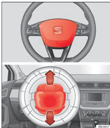
Fig. 20 Airbag del conducente all'interno del volante.
