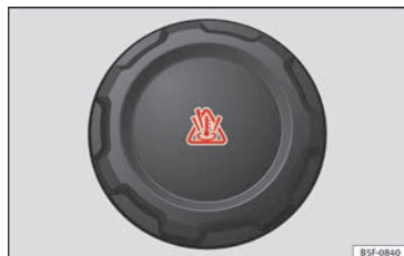
Fig. 66 Vano motore: tappo del serbatoio di compensazione del liquido di raffreddamento.
