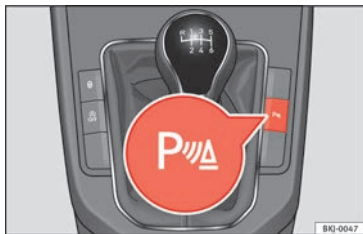
Fig. 216 Console centrale: tasto dell'assistenza per il parcheggio.
