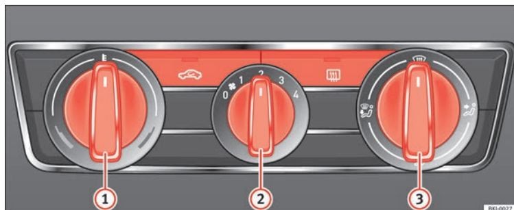
Fig. 62 Sulla console centrale: comandi dell'impianto di riscaldamento e di ventilazione.
