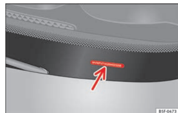
Fig. 243 Numero di telaio.
