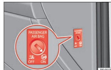
Fig. 22 Commutatore dell'airbag frontale del passeggero.
