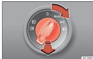
Fig. 144 Plancia portastrumenti: interruttore delle luci.
