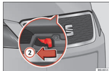
Fig. 10 Leva sotto il cofano del vano motore.
