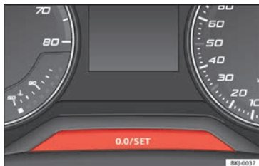
Fig. 125 Quadro strumenti: contachilometri e tasto di azzeramento.
