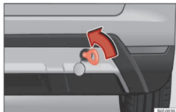
Fig. 85 Paraurti posteriore destro: occhiello di traino.
