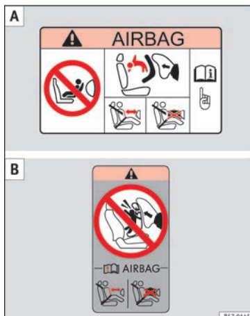
Fig. 27 Adesivi dell'airbag - versione 1: sull'alletta parasole lato passeggero A e nel telaio posteriore della porta del passeggero B.
