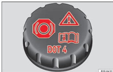
Fig. 67 Vano motore: tappo del serbatoio del liquido dei freni.
