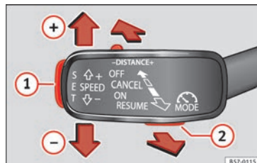
Fig. 186 A sinistra del piantone dello sterzo: terza leva per utilizzare il regolatore di velocità.
