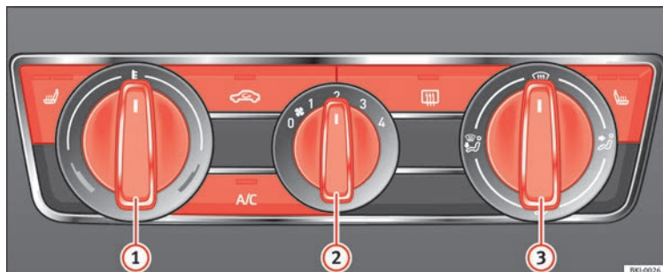
Fig. 62 Sulla console centrale: comandi manuali del climatizzatore.
