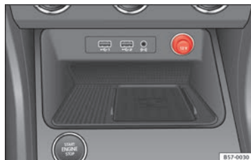
Fig. 148 Centre console: 12 volt socket
