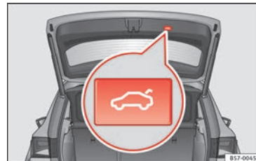
Fig. 129 Portellone del bagagliaio aperto: tasto per chiudere il portellone immediatamente.
