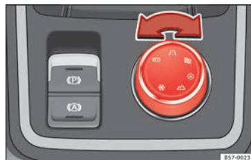
Fig. 197 Console centrale: Manopola di comando (Driving Experience button).
