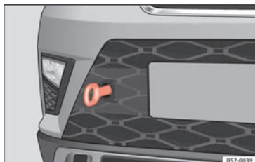
Fig. 74 Paraurti anteriore destro: occhio di traino avvitato.
