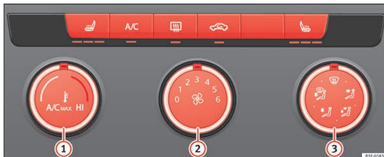
Fig. 56 Sulla console centrale: comandi manuali del climatizzatore.
