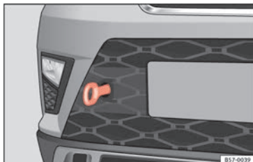
Fig. 98 Sul lato destro del paraurti anteriore: occhiello di traino avvitato.
