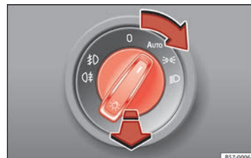
Fig. 35 Plancia portastrumenti: interruttore delle luci.
