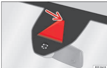
Fig. 193 Nel parabrezza: area del campo visivo della telecamera del dispositivo di assistenza per il mantenimento della corsia.
