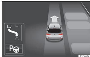
Fig. 204 Sul display del quadro strumenti: visualizzazione dell'assistente di parcheggio con visualizzazione ridotta.
