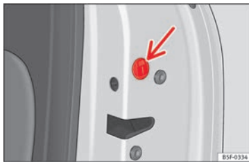
Fig. 4 Blocco di emergenza della porta.
