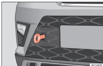
Fig. 75 Paraurti anteriore destro: occhiello di traino avvitato.
