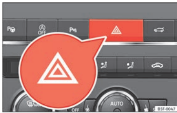
Fig. 137 Plancia portastrumenti: interruttore lampeggio di emergenza.
