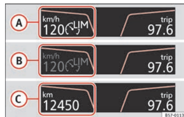
Fig. 174 Sul display del quadro strumenti: indicazioni dello stato del limitatore di velocità.
