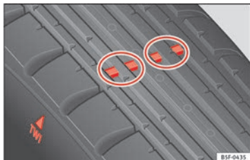
Fig. 227 Spessore del battistrada dello pneumatico: indicatori di usura.
