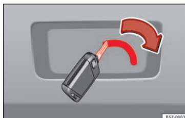
Fig. 8 Particolare del bagagliaio: sblocco di emergenza.
