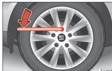
Fig. 72 Ruota: allentare le viti della ruota.
