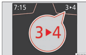
Fig. 45 Quadro strumenti: Assistente cambio marce (cambio manuale).
