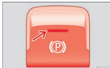
Fig. 167 Nella parte inferiore della console centrale: tasto del freno di stazionamento elettronico.
