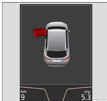
Fig. 50 Sul display del quadro strumenti: indicazione di porte aperte.
