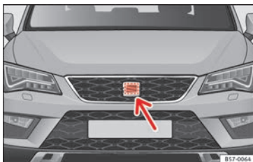
Fig. 179 Nella parte anteriore, dietro allo stemma SEAT: sensore radar.
