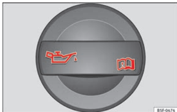
Fig. 225 Vano motore: tappo del bocchettone di rifornimento dell'olio motore.
