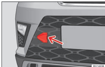
Fig. 97 Sul lato destro del paraurti anteriore: estrarre il coperchio.
