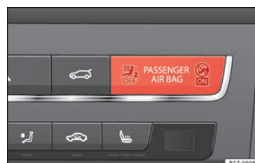
Fig. 51 Spia per la disattivazione dell'airbag del passeggero.
