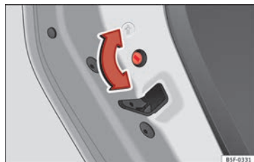
Fig. 129 Sicura per bambini della porta sinistra.
