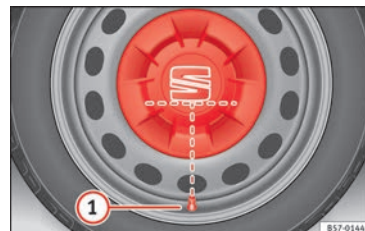
Fig. 69 Posizionamento corretto del copricerchio centrale per cerchi in acciaio.
