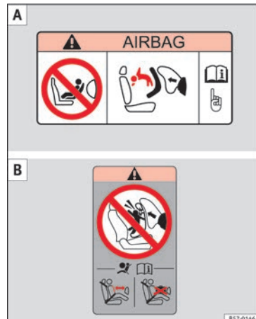
Fig. 29 Adesivi dell'airbag - versione 2: sull'alletta parasole lato passeggero [A] e nel telaio posteriore della porta del passeggero [B].
