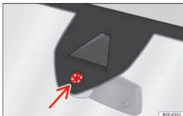
Fig. 141 Superficie sensibile del sensore pioggia
