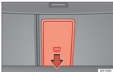
Fig. 155 Nel bagagliaio: apertura della sponda.
