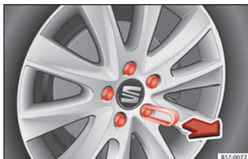
Fig. 70 Ruota: viti della ruota con tappi.
