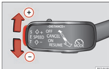
Fig. 181 A sinistra del piantone dello sterzo: terza leva per utilizzare il sistema di regolazione automatica della velocità.
