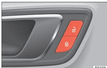
Fig. 2 Porta del conducente: interruttore della chiusura centralizzata.
