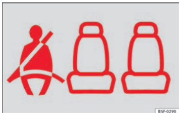
Fig. 87 Quadro strumenti: indicazione di sedili posteriore destro occupato e di corrispondente cintura di sicurezza allacciata.
