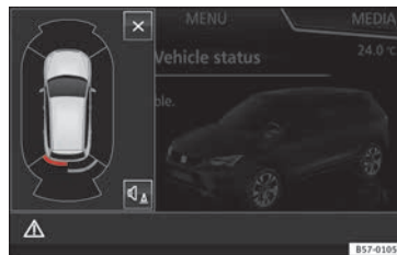
Fig. 220 Indicazione in miniatura dell'attivazione automatica
