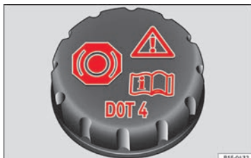
Fig. 62 Vano motore: tappo del serbatoio del liquido dei freni.
