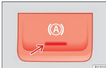
Fig. 177 Nella parte inferiore della console centrale: tasto della funzione Auto Hold.
