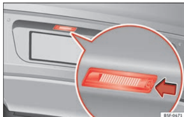
Fig. 114 Nel paraurti posteriore: luce della targa.
