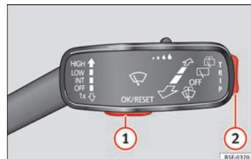
Fig. 42 Leva dell'impianto tergicristalli con display multifunzione.
