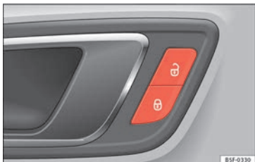
Fig. 2 Porta del conducente: interruttore della chiusura centralizzata.
