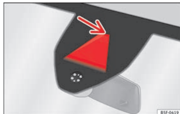
Fig. 199 Nel parabrezza: area del campo visivo della telecamera del dispositivo di assistenza per il mantenimento della corsia.
