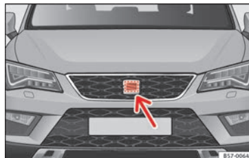
Fig. 185 Nella parte anteriore, dietro allo stemma SEAT: sensore radar.
