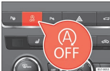
Fig. 176 Consolle centrale: tasto del sistema Start/Stop.
