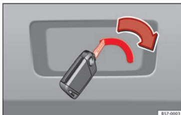
Fig. 8 Particolare del bagagliaio: sblocco di emergenza.
