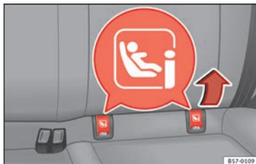
Fig. 31 Occhielli di fissaggio del sistema ISO-FIX/iSize.
