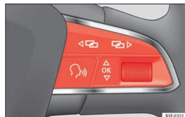
Fig. 43 Lato destro del volante multifunzione: tasti di controllo.
