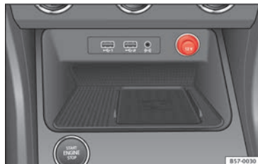
Fig. 153 Consola centrale: presa elettrica da 12 Volt.
