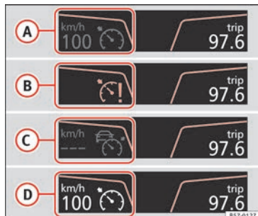
Fig. 178 Display del quadro strumenti: indicazioni sullo stato del GRA.
