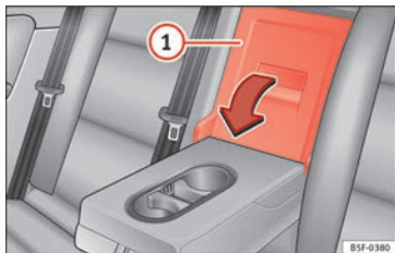
Fig. 158 Sullo schienale del sedile posteriore: apertura della sponda.
