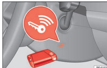
Fig. 171 A destra del piantone dello sterzo: avviamento di emergenza.
