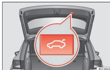
Fig. 6 Portellone posteriore: tasto per chiudere il portellone.
