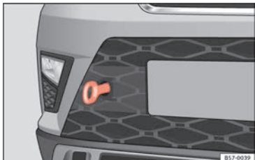
Fig. 75 Paraurti anteriore destro: occhietto di traino avvitato.
