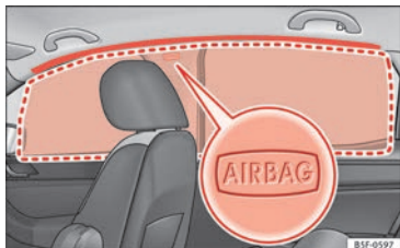
Fig. 27 Posizione degli airbag per la testa.
