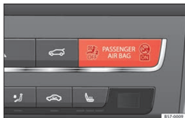
Fig. 51 Spia per la disattivazione dell'airbag del passeggero.
