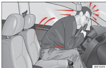
Fig. 89 Il conducente che non indossa la cintura di sicurezza viene scaraventato in avanti
