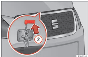
Fig. 10 Leva sotto il cofano del vano motore.
