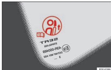
Fig. 86 Etichetta di avvertimento della posizione del poggiatesta.
