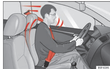
Fig. 88 I conducenti che hanno la cintura di sicurezza correttamente allacciata non saranno proiettati fuori dal veicolo in caso di frenate repentine.
