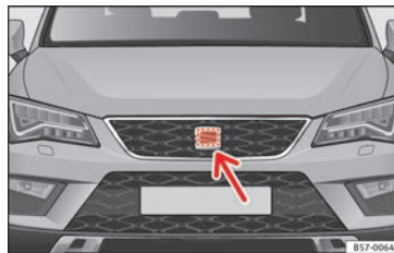
Fig. 193 Nella parte anteriore, dietro allo stemma SEAT: sensore radar.
