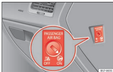
Fig. 22 Commutatore dell'airbag frontale del passeggero.
