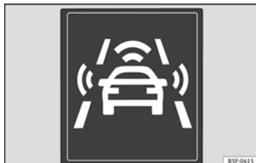
Fig. 195 Sul display del quadro strumenti: indicazione di preavvertimento.
