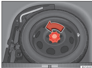
Fig. 241 Ruotino di scorta: piano di carico sollevato.
