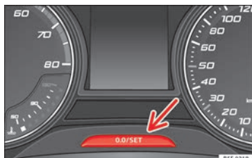
Fig. 118 Quadro strumenti: contachilometri e tasto di azzeramento.
