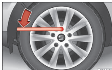
Fig. 72 Ruota: allentare le viti della ruota.
