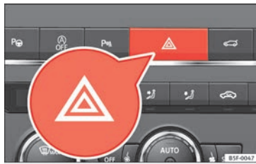
Fig. 140 Plancia portastrumenti: interruttore lampeggio di emergenza.
