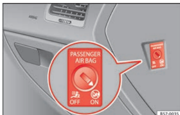
Fig. 94 Commutatore dell'airbag frontale del passeggero.
