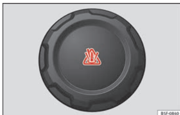
Fig. 61 Vano motore: tappo del serbatoio di compensazione del liquido di raffreddamento.
