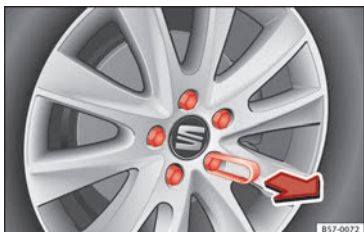
Fig. 70 Ruota: viti della ruota con tappi.
