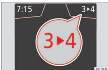
Fig. 46 Quadro strumenti: Assistente cambio marce (cambio manuale).
