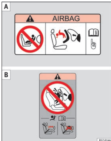
Fig. 29 Adesivi dell'airbag - versione 2: sull'aletta parasole lato passeggero A e nel telaio posteriore della porta del passeggero B .
