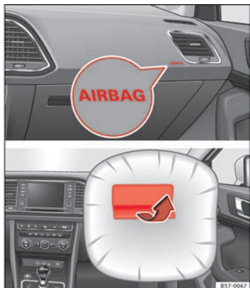
Fig. 21 Airbag del passeggero sul cruscotto.
