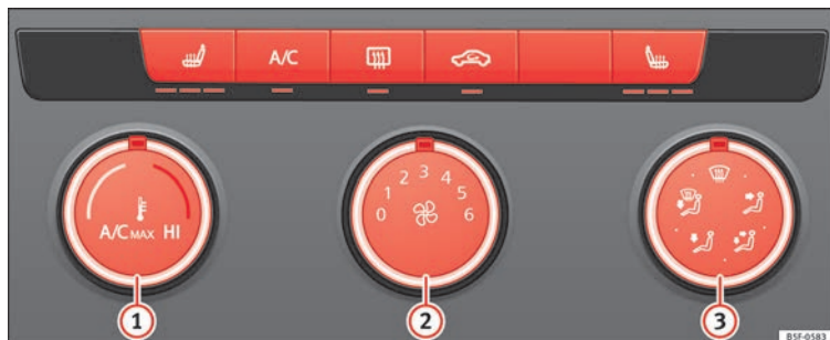
Fig. 56 Sulla console centrale: comandi manuali del climatizzatore.
