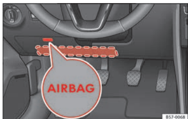
Fig. 23 Sul lato del conducente: posizione dell'airbag per le ginocchia.
