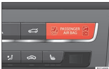
Fig. 95 Spia per la disattivazione dell'airbag del passeggero.
