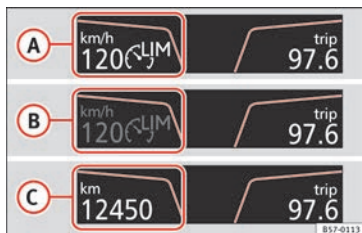
Fig. 179 Sul display del quadro strumenti: indicazioni dello stato del limitatore di velocità.
