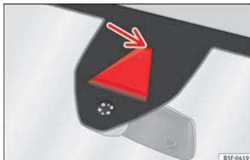
Fig. 202 Nel parabrezza: area del campo visivo della telecamera del dispositivo di assistenza per il mantenimento della corsia.
