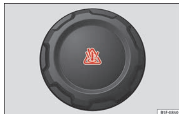
Fig. 63 Vano motore: tappo del serbatoio di compensazione del liquido di raffreddamento.
