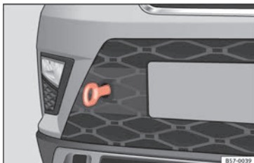
Fig. 99 Sul lato destro del paraurti anteriore: occhiello di traino avvitato.
