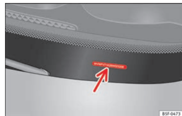
Fig. 249 Numero di telaio.
