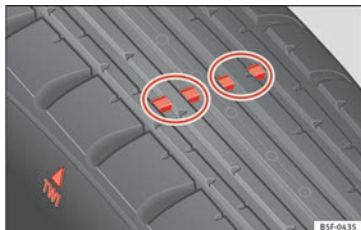
Fig. 243 Spessore del battistrada dello pneumatico: indicatori di usura.
