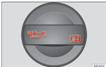
Fig. 241 Vano motore: tappo del bocchettone di rifornimento dell'olio motore.
