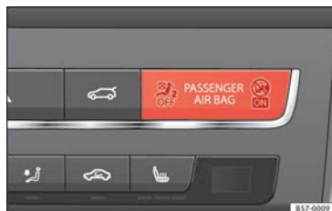
Fig. 53 Spia per la disattivazione dell'airbag del passeggero.
