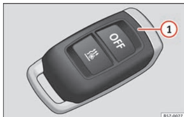
Fig. 176 Riscaldamento autonomo: telecomando a radiofrequenza.
