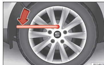
Fig. 74 Ruota: allentare le viti della ruota.
