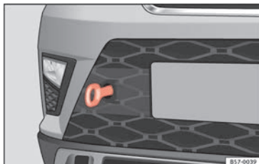
Fig. 77 Paraurti anteriore destro: occhio di traino avvitato.
