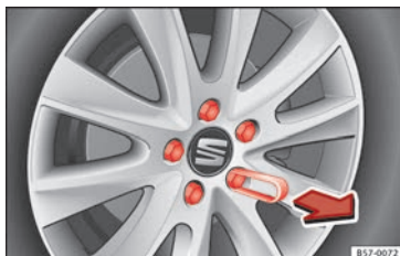
Fig. 72 Ruota: viti della ruota con tappi.
