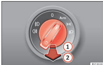
Fig. 143 Plancia portastrumenti: interruttore delle luci.
