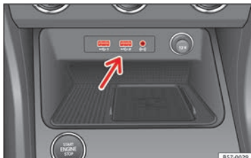
Fig. 124 Console centrale: porta USB/AUX-IN.
