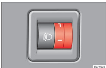
Fig. 145 Accanto al volante: regolatore della profondità dei fari.
