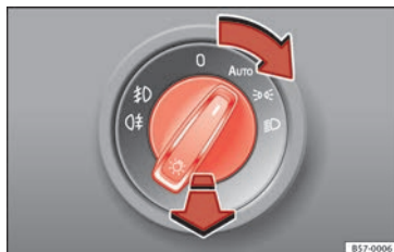
Fig. 36 Plancia portastrumenti: interruttore delle luci.
