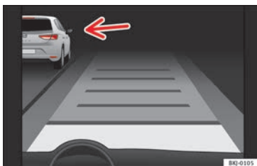
Fig. 199 Sul display del quadro strumenti: ACC attivo, veicolo rilevato sulla sinistra
