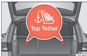
Fig. 33 Posizione degli occhielli Top Tether nella parte posteriore del sedile posteriore.
