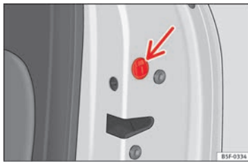
Fig. 4 Blocco di emergenza della porta.
