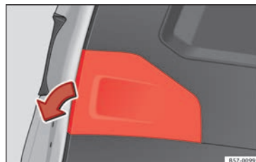
Fig. 113 Portellone posteriore aperto: estrarre il coperchio.
