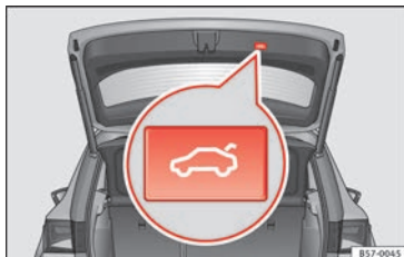
Fig. 137 Portellone posteriore aperto: tasto per chiudere il portellone immediatamente.
