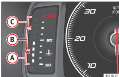
**Fig. 4** Indicatore della temperatura del liquido di raffreddamento del motore nel SEAT Digital Cockpit.
