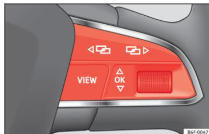
**Fig. 5** Lato destro del volante multifunzionale: tasti per l'uso dei menu e delle indicazioni informative del quadro strumenti.
