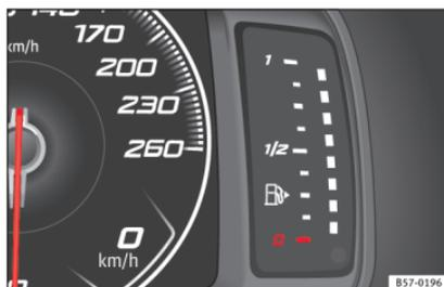
**Fig. 3** Indicatore del livello del carburante nel SEAT Digital Cockpit.
