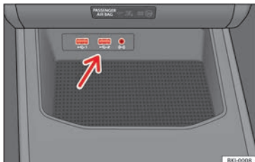
Fig. 132 Centre console: USB/AUX-IN input.
