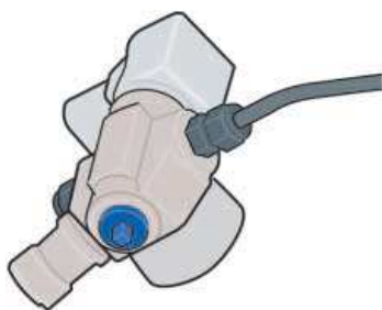
handbediende afsluitkraan aan de voet van de flessenklep.
