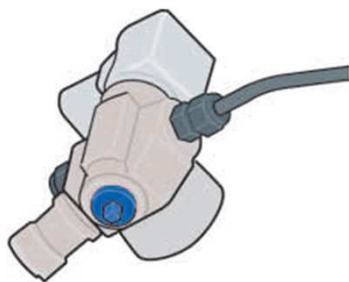
Válvula de cierre manual al pie de la válvula de botella
