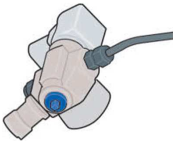
robinet d'arrêt au pied de la vanne.
