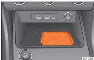
Fig. 29 Consolle centrale: Connectivity Box (Ateca)
