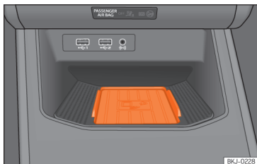
Fig. 28 Consolle centrale: Connectivity Box (Arona, Ibiza)
