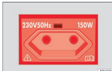
Fig. 194 Rear centre console: 230 Volt Euro power socket
