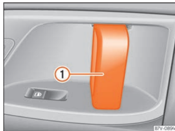
Fig. 136 On the sliding door: door handle ①.
