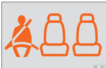
Fig. 88 Quadro strumenti: indicazione di sedile posteriore destro occupato e di corrispondente cintura di sicurezza allacciata.
