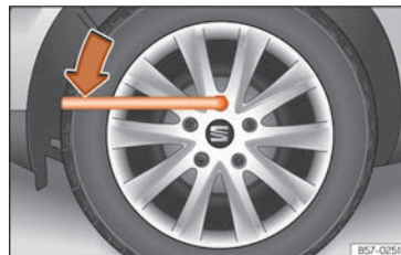
Fig. 72 Cambio di una ruota: allentare le viti della ruota.
