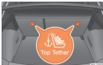
Fig. 38 Posizione degli occhielli Top Tether nella parte posteriore del sedile posteriore.
