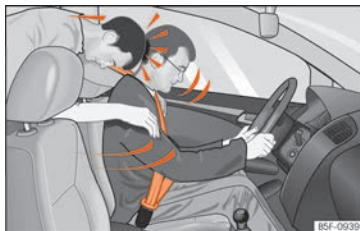
Fig. 91 Se non indossa la cintura, il passeggero seduto sul sedile posteriore viene scagliato in avanti, colpendo il conducente (che invece indossa la cintura)
