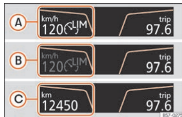
Fig. 226 Sul display del quadro strumenti: indicazioni dello stato del limitatore di velocità.
