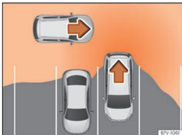
Fig. 245 Rappresentazione schematica dell'assistente di uscita dal parcheggio: zona vigilata attorno al veicolo che sta uscendo dal parcheggio.
