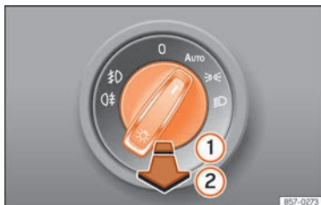
Fig. 142 Plancia portastrumenti: interruttore delle luci.
