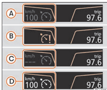
Fig. 226 Display del quadro strumenti: indicazioni sullo stato del GRA.
