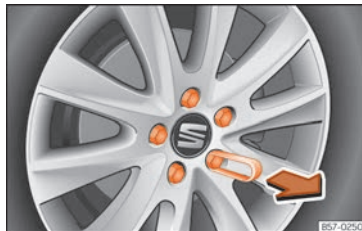
Fig. 71 Ruota: viti della ruota con tappi.
