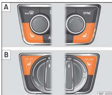
Fig. 150 Sulla console centrale: regolatore per il riscaldamento dei sedili anteriori. [A]: versione con Climatronic. [B]: versione con climatizzatore manuale.
