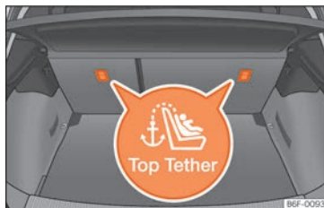
Fig. 34 Posizione degli occhielli Top Tether nella parte posteriore del sedile posteriore.
