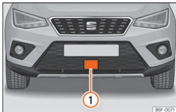
Fig. 236 Sul paraurti anteriore: sensore radar.
