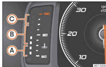
Fig. 125 Quadro strumenti digitale: indicatore della temperatura del liquido di raffreddamento
