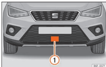
Fig. 231 Sul paraurti anteriore: sensore radar.
