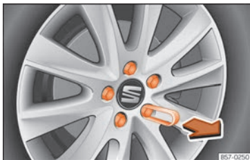
Fig. 35 Ruota: viti della ruota con tappi.
