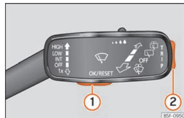
Fig. 78 Leva del tergicristalli: tasti di controllo.
