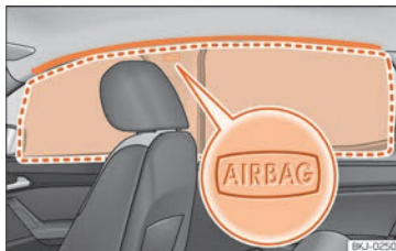
Fig. 21 Posizione e campo d'azione dell'airbag per la testa.
