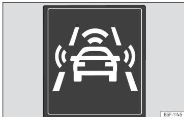
Fig. 227 Sul display del quadro strumenti: indicazioni di preavvertimento.
