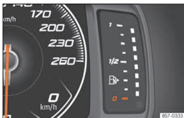
Fig. 74 Quadro strumenti digitale: indicatore del livello del carburante.
