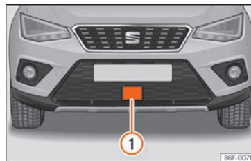
Fig. 234 Sul paraurti anteriore: sensore radar.
