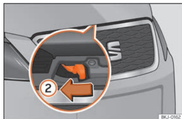
Fig. 280 Leva sotto il cofano del vano motore.
