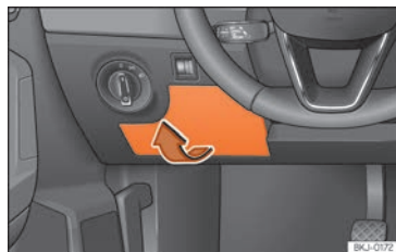
Fig. 50 Sul cruscotto, lato del conducente: coperchio della scatola dei fusibili.
