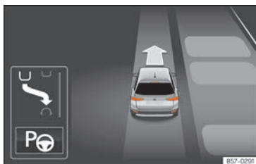
Fig. 248 Sul display del quadro strumenti: visualizzazione dell'assistente di parcheggio con visualizzazione ridotta.
