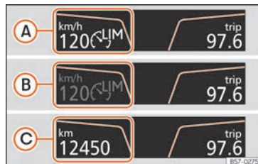
Fig. 224 Sul display del quadro strumenti: indicazioni dello stato del limitatore di velocità.
