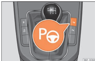
Fig. 247 Sulla console centrale: tasto per inserire l'assistente di parcheggio.
