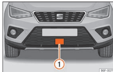
Fig. 228 Sul paraurti anteriore: sensore radar.
