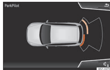
Fig. 258 Visualizzazione di assistenza per il parcheggio sul display del sistema Easy Connect.
