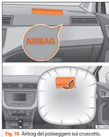
Fig. 16 Airbag del passeggero sul cruscotto.
