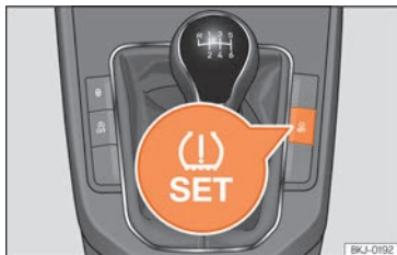
Fig. 291 Console centrale: tasto del sistema di controllo degli pneumatici.
