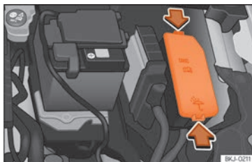
Fig. 51 Nel vano motore: coperchio della scatola dei fusibili.
