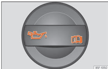
Fig. 283 Vano motore: tappo del bocchettone di rifornimento dell'olio motore.
