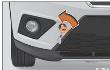
Fig. 47 Paraurti anteriore destro: occhiello di traino avvitato.
