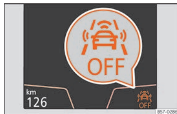
Fig. 229 Sul display del quadro strumenti: indicazione di Front Assist disattivato.
