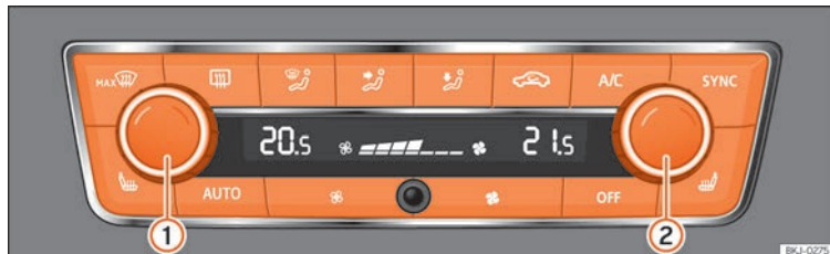
Fig. 137 Sulla console centrale: comandi del Climatronic.
