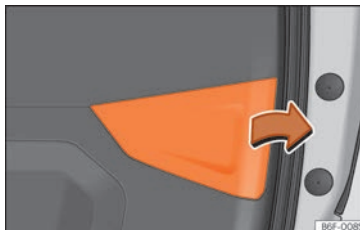
Fig. 61 Portellone posteriore aperto: estrarre il coperchio.
