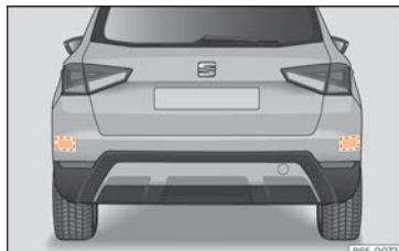
Fig. 241 Vista posteriore del veicolo: zone dei sensori radar.
