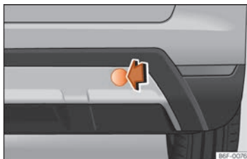
Fig. 48 Sul lato destro del paraurti posteriore: estrarre il coperchio.
