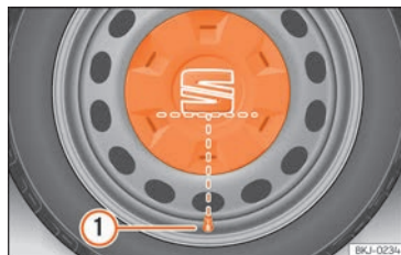
Fig. 34 Posizionamento corretto del copricerchio centrale per cerchi in acciaio.
