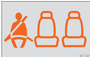
Fig. 6 Quadro strumenti: indicazione del sedile posteriore sinistro occupato e relativa cintura allacciata.
