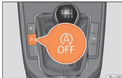
**Fig. 212** Consolle centrale: tasto del sistema Start/Stop.
