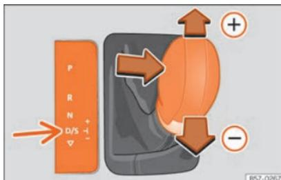
Fig. 215 Leva selettoria in posizione Tiptronic
