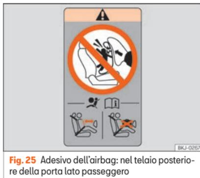
**Fig. 25** Adesivo dell'airbag: nel telaio posteriore della porta lato passeggero
