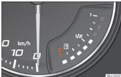
**Fig. 73** Quadro strumenti analogico: indicatore del livello del carburante
