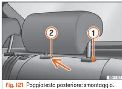
**Fig. 121** Poggiatesta posteriore: smontaggio.
