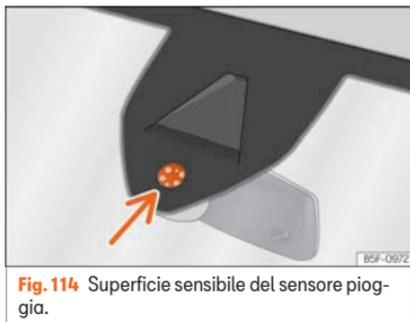
**Fig. 114** Superficie sensibile del sensore pioggia.
