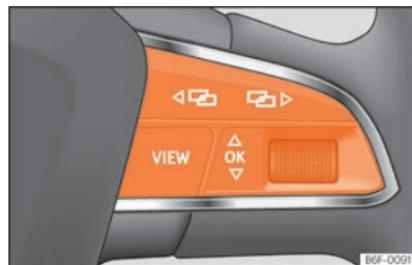
**Fig. 79** Lato destro del volante multifunzione: tasti per l'utilizzo dei menu e delle indicazioni informative del quadro strumenti.
