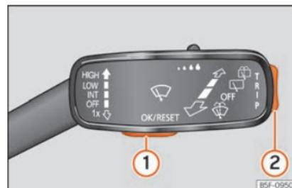
**Fig. 78** Leva del tergicristalli: tasti di controllo. »
