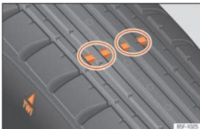
**Fig. 289** Spessore del battistrada dello pneumatico: indicatori di usura.
