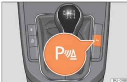
**Fig. 254** Console centrale: tasto dell'assistenza per il parcheggio (in base alla versione).
