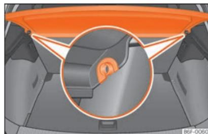
Fig. 126 Nel bagagliaio: smontare e montare il ripiano.
