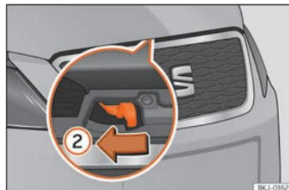
**Fig. 280** Leva sotto il cofano del vano motore.
