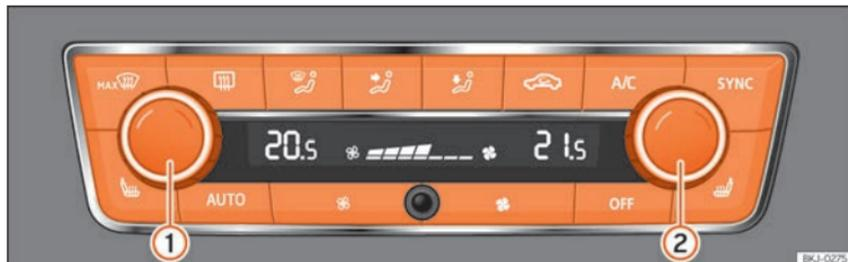
**Fig. 137** Sulla consola centrale: comandi del Climatronic.
