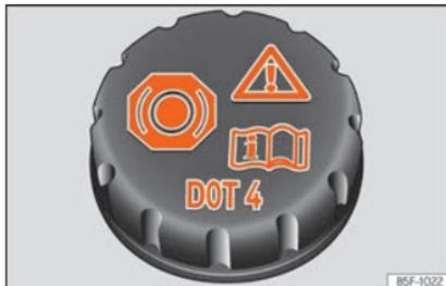
Fig. 286 Vano motore: tappo del serbatoio del liquido dei freni.
