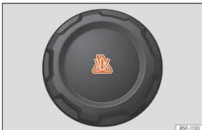
**Fig. 285** Vano motore: tappo del serbatoio di compensazione del liquido di raffreddamento.
