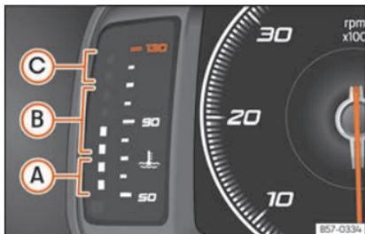
**Fig. 77** Quadro strumenti digitale: indicatore della temperatura del liquido di raffreddamento.
