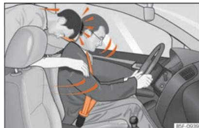
**Fig. 9** Se non indossa la cintura, il passeggero seduto sul sedile posteriore viene scagliato in avanti, colpendo il conducente (che invece indossa la cintura)
