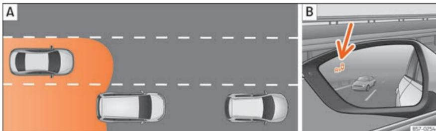
**Fig. 242** Rappresentazione schematica: **A** Situazione in un sorpasso con traffico sulla parte posteriore. **B** Indicazione dell'assistente angolo cieco sullo specchietto retrovisore esterno sinistro.
