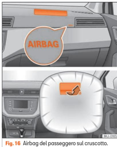
**Fig. 16** Airbag del passeggero sul cruscotto.
