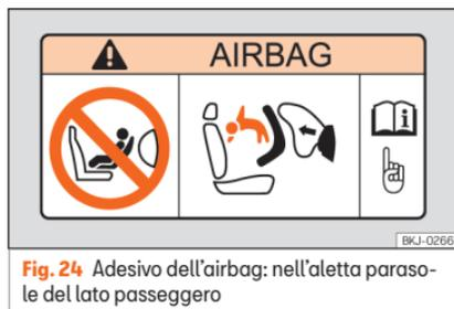
**Fig. 24** Adesivo dell'airbag: nell'aletta parasole del lato passeggero
