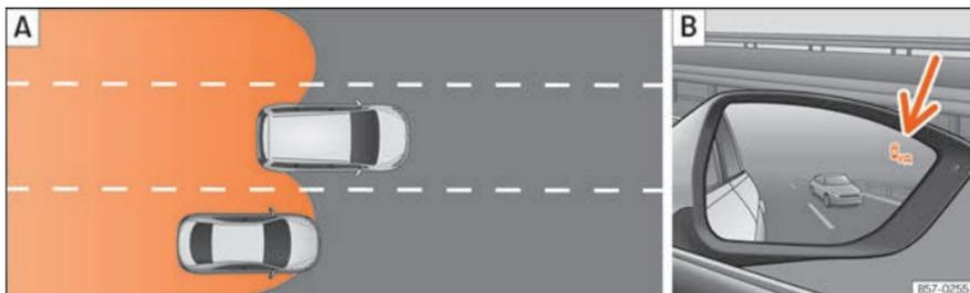
**Fig. 243** Rappresentazione schematica: **A** Situazione in un sorpasso e incorporamento successivo alla corsia destra. **B** Indicazione dell'assistente angolo cieco sullo specchietto retrovisore esterno destro.
