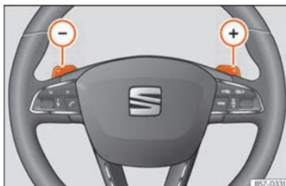
Fig. 216 Volante: leve per il cambio automatico.
