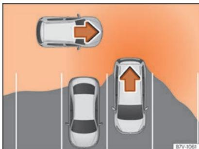
**Fig. 244** Rappresentazione schematica dell'assistente di uscita dal parcheggio: zona vigilata attorno al veicolo che sta uscendo dal parcheggio.
