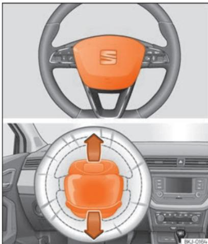
**Fig. 15** Airbag del conducente all'interno del volante.
