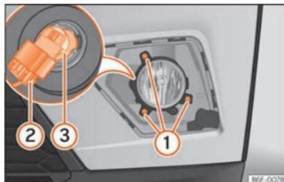
**Fig. 58** Faro fendinebbia: smontaggio del supporto lampade
