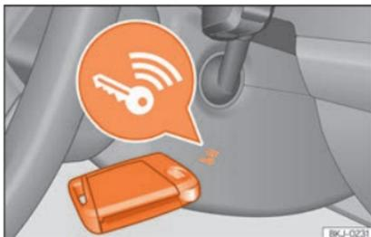
**Fig. 210** A destra del piantone dello sterzo: avviamento di emergenza.
