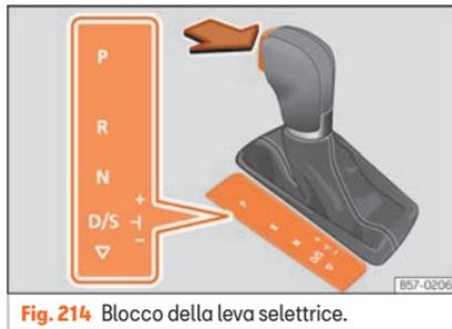
Fig. 214 Blocco della leva selettoria.
