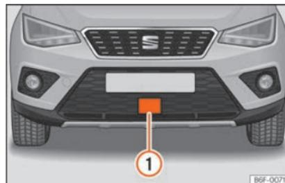
**Fig. 234** Sul paraurti anteriore: sensore radar.
