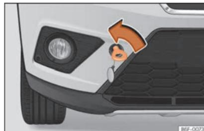
**Fig. 47** Paraurti anteriore destro: occhiello di traino avvitato.
