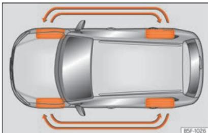
**Fig. 290** Scambio delle ruote.
