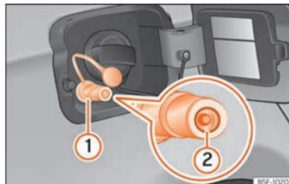
**Fig. 274** Sportellino del serbatoio aperto: bocchettone di rifornimento del gas (1), anello di tenuta del bocchettone di rifornimento (2).
