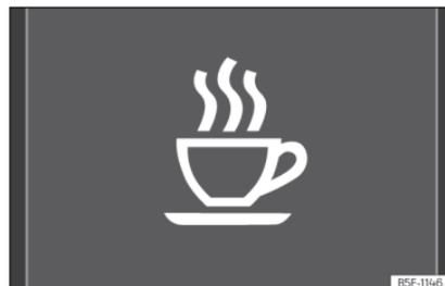
**Fig. 72** Sul display del quadro strumenti: simbolo del riconoscimento della stanchezza del conducente.
