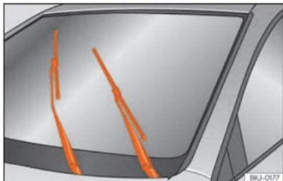
**Fig. 41** Tergicristalli in posizione di manutenzione.
