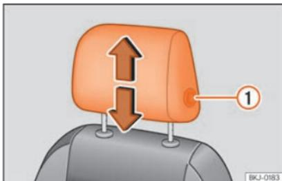
**Fig. 119** Sedile anteriore: regolazione del poggiatesta.
