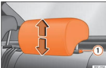
**Fig. 120** Poggiatesta posteriore: regolazione del poggiatesta.
