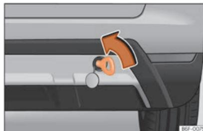
Fig. 49 Sul lato destro dei paraurti posteriore: occhiello di traino avvitato.
