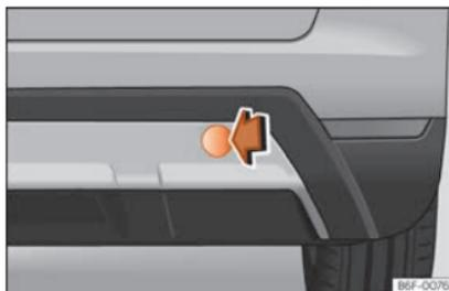
Fig. 48 Sul lato destro dei paraurti posteriore: estrarre il coperchio.
