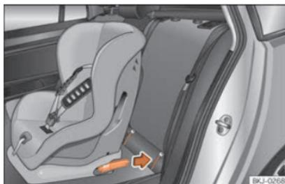
**Fig. 27** Sedili posteriori: Posizionamento dei seggiolini per bambini con sistema ISOFIX.
