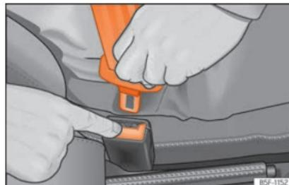
**Fig. 11** Rilasciare la linguetta della chiusura della cintura.
