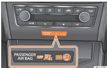
**Fig. 18** Sulla parte centrale del quadro strumenti: spia della disattivazione degli airbag del passeggero anteriore.
