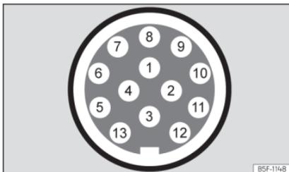
**Fig. 262** Rappresentazione schematica: assegnazione dei pin della presa elettrica per il rimorchio.
