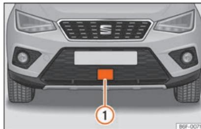
Fig. 228 Sul paraurti anteriore: sensore radar.
