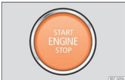
**Fig. 209** Nella parte inferiore della console centrale: pulsante di avviamento.
