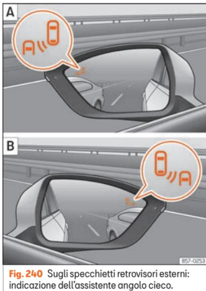
**Fig. 240** Sugli specchietti retrovisori esterni: indicazione dell'assistente angolo cieco.
