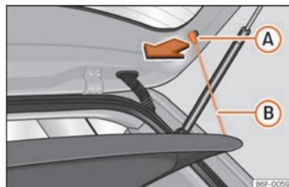
Fig. 125 Nel bagagliaio: smontare e montare il ripiano.
