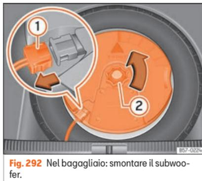
**Fig. 292** Nel bagagliaio: smontare il subwoofer.
