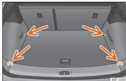
**Fig. 129** Posizione degli occhielli di ancoraggio nel bagagliaio.
