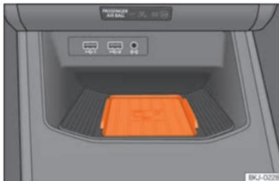
**Fig. 207** Sulla console centrale: alloggiamento per il collegamento del telefono cellulare.
