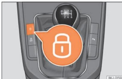
**Fig. 91** Console centrale: pulsante della chiusura centralizzata.
