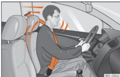
**Fig. 7** I conducenti che hanno la cintura di sicurezza correttamente allacciata non saranno proiettati fuori dal veicolo in caso di frenate repentine.
