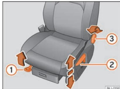
Fig. 118 Sedili anteriori: regolazione manuale del sedile.
