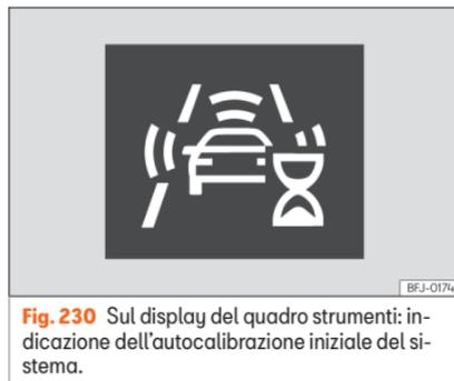
**Fig. 230** Sul display del quadro strumenti: indicazione dell'autocalibrazione iniziale del sistema.
