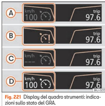
Fig. 221 Display del quadro strumenti: indicazioni sullo stato del GRA.
