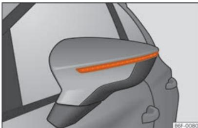
**Fig. 63** Indicatore di direzione integrato nello specchietto retrovisore
