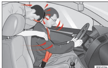
Rys. 89 Pasażer na tylnym siedzeniu, który nie zapiął pasów bezpieczeństwa zostaje gwałtownie wyrzucony do przodu, uderzając kierowcę, który ma zapięty pas.
