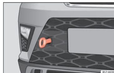
Rys. 74 Prawa strona przedniego zderzaka: wkręcany zaczep linki holowniczej.
