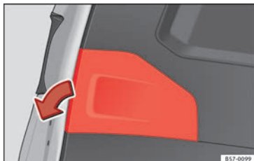
Rys. 110 Wymontowanie osłony przy otwartej pokrywie bagażnika.
