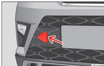
Rys. 96 Prawa strona przedniego zderzaka: zdjąć osłonę gniazda zaczepu.
