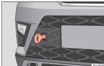
Rys. 97 Prawa strona przedniego zderzaka: wkręcanie zaczepu linki holowniczej.
