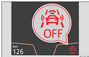
Rys. 186 Na wyświetlaczu w tablicy rozdzielczej: komunikat o wyłączeniu Front Assist
