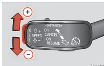
Rys. 181 Po lewej stronie kolumny kierownicy: trzecia dźwignia do obsługi tempomatu ACC.
