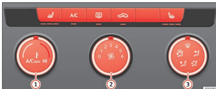
Rys. 56 W konsoli środkowej: Ręczna regulacja klimatyzacji
