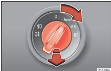
Rys. 35 Tablica rozdzielcza: regulacja natężenia podświetlenia.
