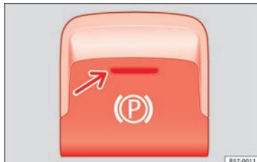
Rys. 167 W dolnej części konsoli środkowej: przycisk elektronicznego hamulca postojowego.
