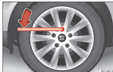
Rys. 72 Koło: Poluzować śruby koła.
