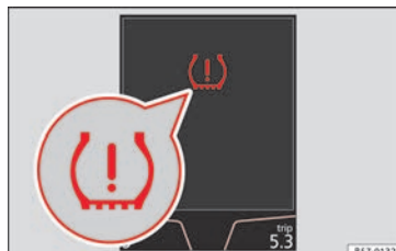
Rys. 229 Na tablicy rozdzielczej: ostrzeżenie o spadku ciśnienia w oponach.
