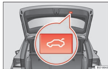
Rys. 6 Kłapa bagażnika: przycisk zamykania klapy,
