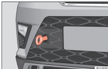
Rys. 98 Z prawej strony zderzaka przedniego: wkręcić zaczep holowniczy.
