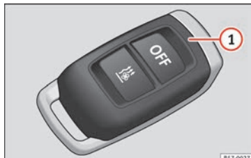
Rys. 164 Nagrzewnica pomocnicza: pilot zdalnego sterowania
