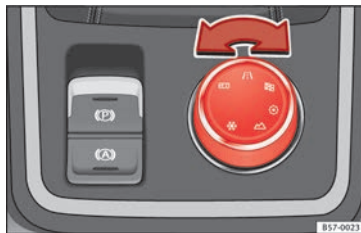
Rys. 199 Konsola środkowa: Przycisk Trybu Jazdy.
