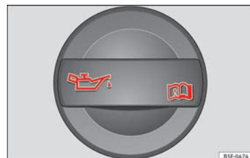
Rys. 60 W komorze silnika: Korek wlewu oleju silnikowego
