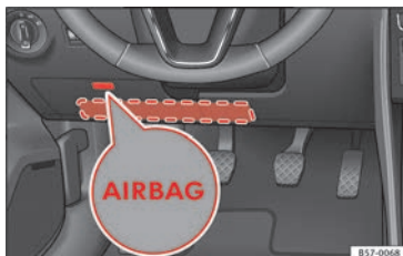
Rys. 23 Po stronie kierowcy: umiejscowienie kolanowej poduszki powietrznej.
