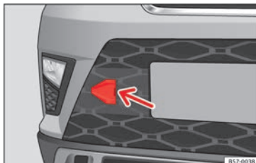
Rys. 97 Z prawej strony zderzaka przedniego: zdjąć zaślepkę.
