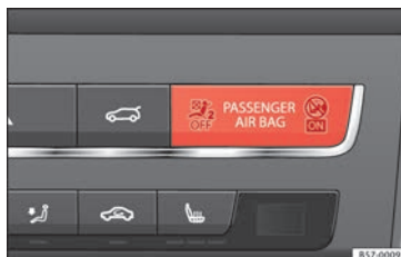
Rys. 95 Lampka ostrzegawcza dezaktywacji czołowej poduszki powietrznej pasażera
