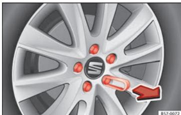
Rys. 70 Koło: śruby koła z kapturkami.
