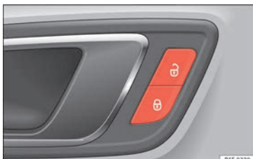
Rys. 2 Drzwi kierowcy: przycisk centralnego zamka.
