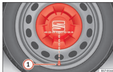
Rys. 69 Prawidłowo założona osłona piasty na felde stalowej.
