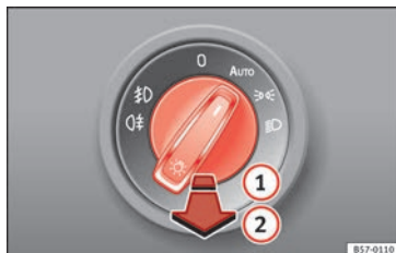
Rys. 136 Tablica rozdzielcza: regulacja natężenia podświetlenia.
