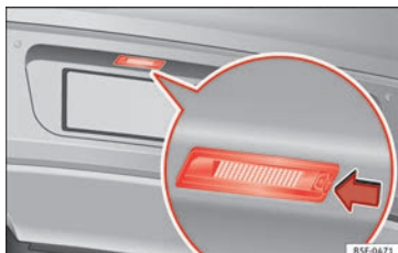
Rys. 114 W tylnym zderzaku: oświetlenie tablicy rejestracyjnej.
