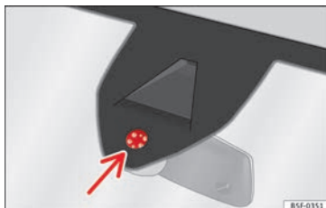
Rys. 141 Powierzchnia aktywna czujnika deszczu.
