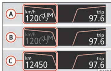
Rys. 174 Na wyświetlaczu tablicy rozdzielczej: komunikaty dot. stanu ogranicznika prędkości.
