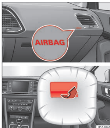
Rys. 21 Czołowa poduszka powietrzna pasażera umieszczona w desce rozdzielczej.
