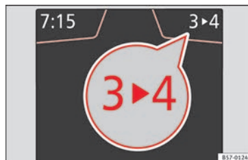
Rys. 45 Tablica rozdzielcza: wskaźnik zalecanego biegu (przy manualnej skrzyni biegów).
