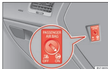
Rys. 22 Przełącznik czołowej poduszki powietrznej pasażera
