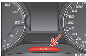
Rys. 118 Tablica rozdzielcza: licznik przebiegu i przycisk zerowania.
