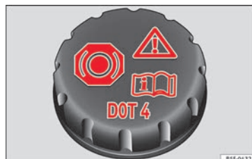
Rys. 62 Komora silnika: korek zbiornika płynu hamulcowego
