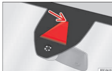
Rys. 193 Na przedniej szybie: pole widzenia kamery Asystenta pasa ruchu
