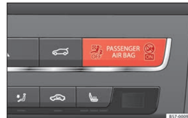
Rys. 51 Lampka ostrzegawcza dezaktywacji czołowej poduszki powietrznej pasażera
