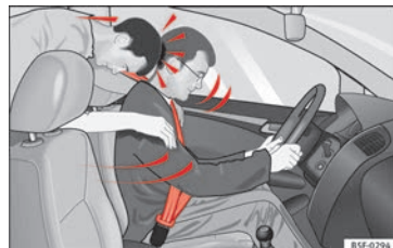
Rys. 90 Pasażer na tylnym siedzeniu nie posiadający zapiętych pasów bezpieczeństwa zostaje gwałtownie wyrzucony do przodu, uderzając kierowcę, który ma zapięty pas.
