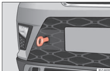
Rys. 75 Prawa strona przedniego zderzaka: wkręcany element mocowania linki holowniczej.
