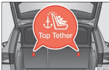
Rys. 32 Umieszczenie uchwytów Top Tether za tylnym siedzeniem.
