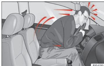
Rys. 89 Kierowca nie posiadający zapiętych pasów bezpieczeństwa zostaje wyrzucony gwałtownie do przodu.
