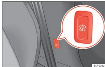
Rys. 130 Przycisk monitoringu wnętrza/ zabezpieczenia przed odholowaniem.
