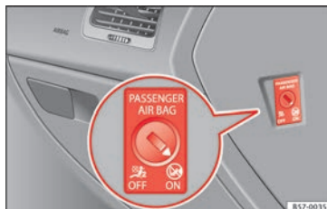
Rys. 94 Przełącznik czołowej poduszki powietrznej pasażera
