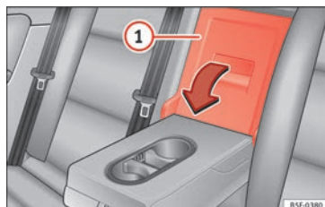
Rys. 154 W oparciu tylnego siedzenia: przejście z kabiny do bagażnika.
