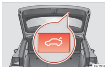
Rys. 131 Otwarta kłapa bagażnika: przycisk szybkiego zamykania kłapy.
