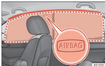
Rys. 27 Umieszczenie poduszek powietrznych chroniących głowę.
