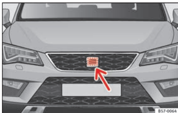
Rys. 179 Z przodu, za znaczkem SEAT-a: czujnik radarowy.
