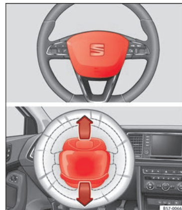
Rys. 20 Poduszka powietrzna kierowcy umieszczona w kierownicy.
