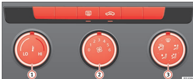
Rys. 57 Na konsoli środkowej: system ogrzewania i sterowanie nawiewem świeżego powietrza.
