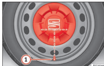
Rys. 69 Prawidłowo założona osłona piasty na feldze stalowej.
