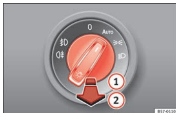
Rys. 139 Tablica rozdzielcza: przełącznik światel.
