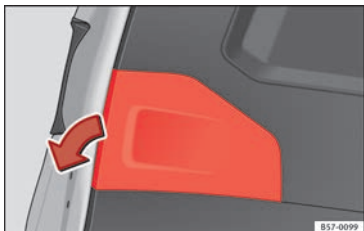
Fig. 113 Rear lid open: remove the lid.
