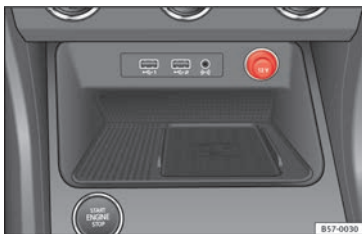
Fig. 157 Centre console: 12 volt socket
