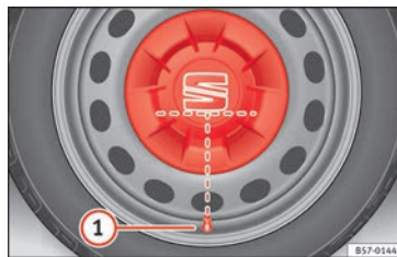
Rys. 71 Prawidłowo założona osłona piasty na feldzie stalowej.
