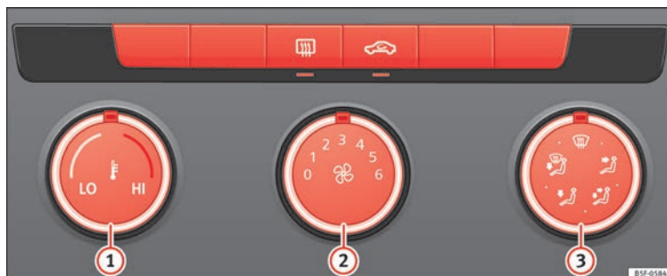
Rys. 59 Na konsoli środkowej: system ogrzewania i sterowanie nawiewem świeżego powietrza.
