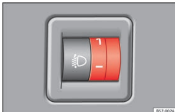
Rys. 145 Obok kolumny kierownicy: Pokrętko regulacji zasięgu reflektorów
