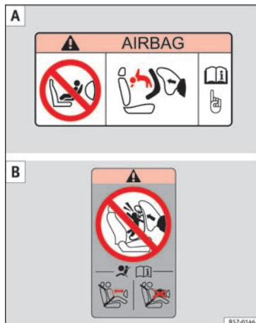
Rys. 30 Plakietki informujące o poduszkach powietrznych - wersja 2: na osłonie przeciwsłonecznej pasażera [A] oraz w tylnej części ramy drzwi pasażera z przodu [B].
