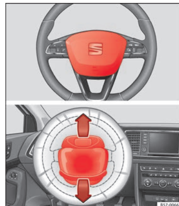
Rys. 20 Poduszka powietrzna kierowcy umieszczona w kierownicy.
