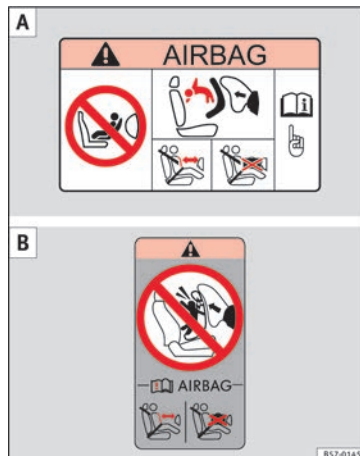
Rys. 29 Plakietki informujące o poduszkach powietrznych - wersja 1: na osłonie przeciwsłonecznej pasażera A oraz w tylnej części ramy drzwi pasażera z przodu B .
