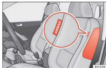
Rys. 26 Boczna poduszka powietrzna w fotelu kierowcy.
