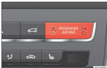
Rys. 96 Deska rozdzielcza: lampka kontrolna wylaczenia czołowej poduszki pasażera w konsoli środkowej.
