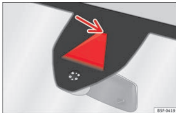
Rys. 202 Na przedniej szybie: pole widzenia kamery Asystenta pasa ruchu
