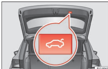
Rys. 137 Otwarta kłapa bagażnika: przycisk szybkiego zamykania klapy.
