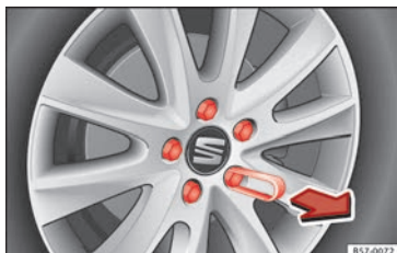
Rys. 72 Koło: śruby koła z nasadkami.
