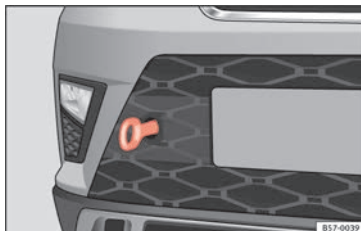
Rys. 99 Z prawej strony zderzaka przednie- go: wkręcić pierścień holowniczy.
