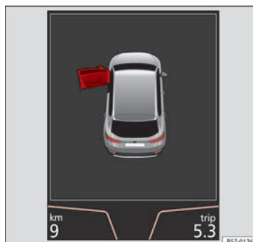
Rys. 52 Na wyświetlaczu tablicy rozdzielczej: niezamknięte drzwi.
