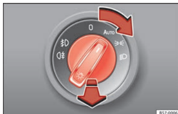
Rys. 36 Tablica rozdzielcza: przełącznik świateł.
