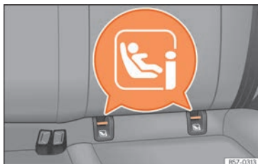
Fig. 39 Occhielli di fissaggio del sistema ISO-FIX/iSize.
