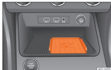
Fig. 239 Sulla console centrale: alloggiamento per il collegamento del telefono cellulare.
