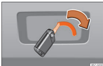
Fig. 11 Particolare del bagagliaio: sblocco di emergenza.
