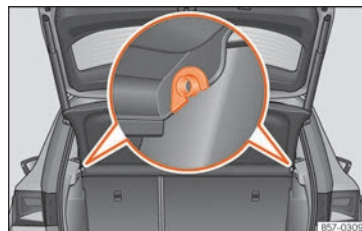
Fig. 171 Nel bagagliaio: smontare e montare il ripiano.
