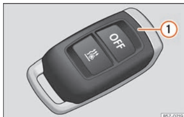
Fig. 187 Riscaldamento autonomo: telecomando a radiofrequenza.
