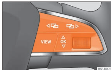
Fig. 133 Lato destro del volante multifunzione: tasti per l'utilizzo dei menu e delle indicazioni informative del quadro strumenti.
