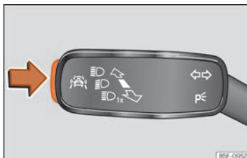
Fig. 134 Sulla leva degli indicatori di direzione e degli abbaglianti: tasti per i sistemi di assistenza alla guida.
