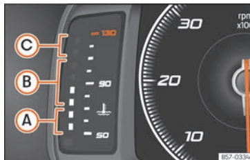
Fig. 131 Quadro strumenti digitale: indicatore della temperatura del liquido di raffreddamento
