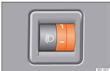
Fig. 154 Accanto al volante: regolatore della profondità dei fari.
