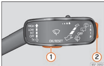
Fig. 132 Leva dell'impianto tergicristalli tasti di controllo.
