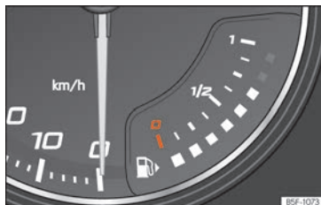
Fig. 128 Quadro strumenti analogico: indicatore del livello del carburante
