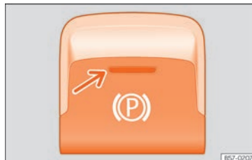
Fig. 243 Nella parte inferiore della console centrale: tasto del freno di stazionamento elettronico.
