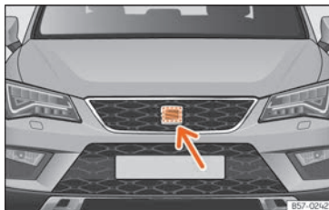
Fig. 255 Nella parte anteriore, dietro allo stemma SEAT: sensore radar.
