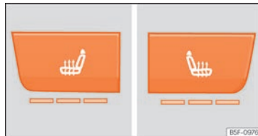
Fig. 160 Sulla console centrale: regolatore per il riscaldamento dei sedili anteriori.
