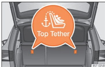
Fig. 40 Posizione degli occhielli Top Tether nella parte posteriore del sedile posteriore.
