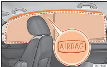
Fig. 34 Posizione degli airbag per la testa.
