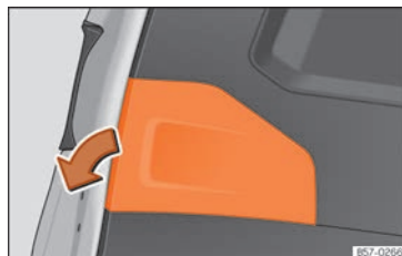
Fig. 116 Portellone posteriore aperto: estrarre il coperchio.
