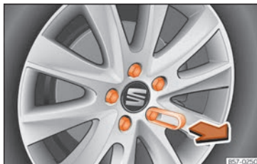
Fig. 75 Ruota: viti della ruota con tappi.
