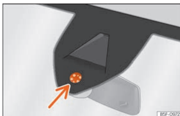
Fig. 157 Superficie sensibile del sensore pioggia
