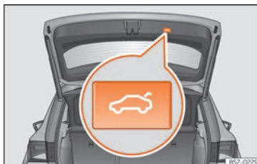
Fig. 145 Portellone posteriore aperto: tasto per chiudere il portellone immediatamente.
