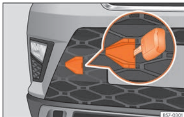
Fig. 101 Sul lato destro del paraurti anteriore: estrarre il coperchio.
