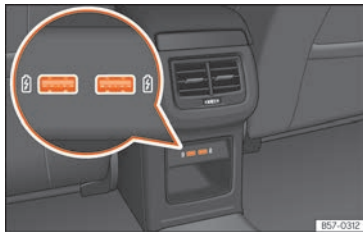
Fig. 237 Parte posteriore della console centrale: connettori USB.
