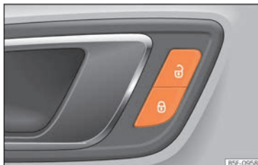
Fig. 5 Porta del conducente: interruttore della chiusura centralizzata.
