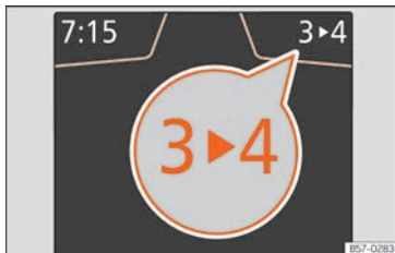
Fig. 247 Quadro strumenti: Assistente cambio marce (cambio manuale).
