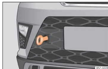
Rys. 80 Prawa strona przedniego zderzaka: wkręcony pierścień holowniczy.
