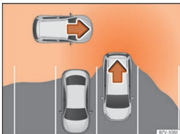
Rys. 275 Schemat asystenta parkowania: obszar wykrywany wokół wyjeżdżającego pojazdu.
