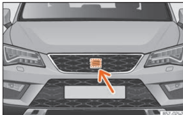
Rys. 255 Z przodu za znacznikiem SEAT-a: czujnik radarowy.
