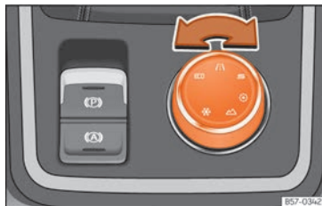
Rys. 277 Konsola środkowa: Przycisk Trybu Jazdy.
