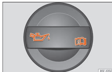
Rys. 306 W komorze silnika: Korek wlewu oleju silnikowego.
