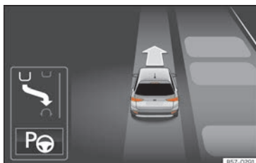
Rys. 282 Na wyświetlaczu tablicy rozdzielczej: widok wspomagania parkowania przy zmniejszonej widoczności.
