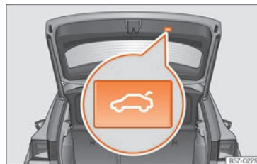
Rys. 9 Pokrywa bagażnika: przycisk zamykania pokrywy.
