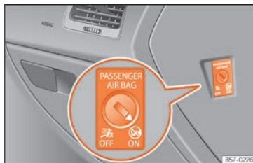
Rys. 28 Przetącznik czołowej poduszki powietrznej pasażera.
