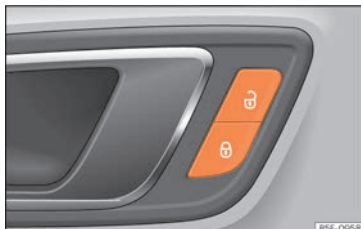
Rys. 5 Drzwi kierowcy: przycisk centralnego zamka.
