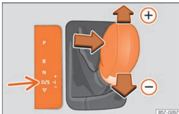
Rys. 245 Konsola środkowa: zmiana biegów w trybie tiptronic
