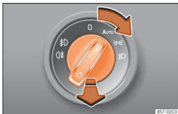
Rys. 44 Tablica przyrządów: przełącznik świateł.
