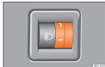
Rys. 154 Obok kolumny kierownicy: regulacja zasięgu reflektorów.
