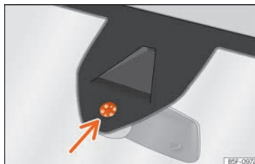
Rys. 157 Powierzchnia aktywna czujnika deszczu
