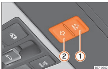
Rys. 149 Na podsufitce: przetącniki rolety przeciwstłonecznej.
