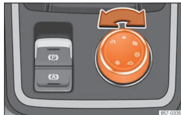
Rys. 278 Konsola środkowa: przycisk Trybu Jazdy w modelu Cupra.
