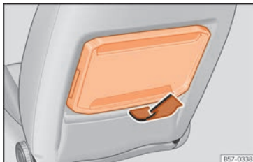
Rys. 164 Lewy fotel przedni: składany stolik.
