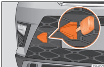
Rys. 101 Z prawej strony zderzaka przedniego: zdjąć zaślepkę.
