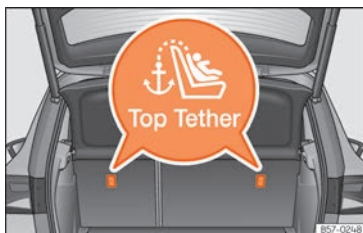
Rys. 40 Umieszczenie uchwytów Top Tether za tylnym siedzeniem.
