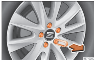
Rys. 75 Koło: śruby koła z nasadkami.
