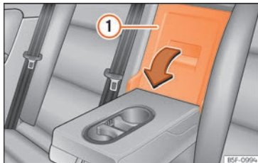
Rys. 174 W oparciu tylnego siedzenia: przeście z kabiny do bagażnika.
