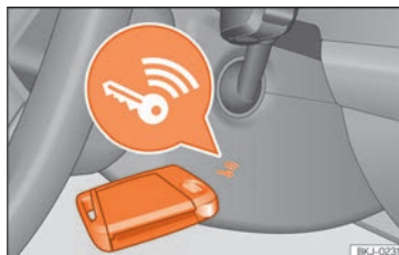
Rys. 242 Po prawej stronie kolumny kierownicy: rozruch awaryjny.
