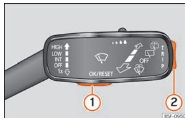
Rys. 132 Dźwignia wycieraczek szyby przedniej: przyciski sterujące.
