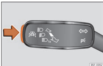
Rys. 134 Na dzwigni kierunkowskazów i świateł drogowych: przycisk systemów wspomagania kierowcy
