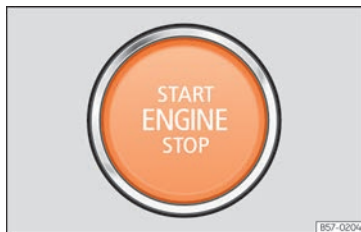
Rys. 241 W dolnej części konsoli środkowej: przycisk rozruchu.
