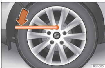
Rys. 77 Koło: poluzować śruby koła.
