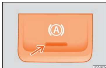
Rys. 249 W dolnej części konsoli środkowej: przycisk funkcji Auto Hold.
