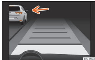
Rys. 263 Na wyświetlaczu tablicy rozdzielczej: ACC aktywny, wykryto pojazd na lewym pasie
