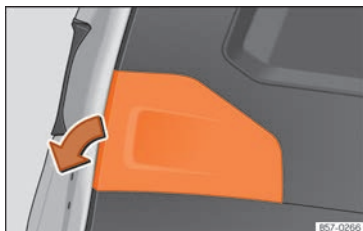
Fig. 116 Rear lid open: remove the lid.
