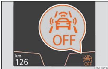
Fig. 256 Sul display del quadro strumenti: indicazione di Front Assist disattivato.
