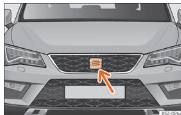
Fig. 260 Nella parte anteriore, dietro allo stemma SEAT: sensore radar.
