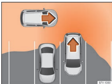
Fig. 275 Rappresentazione schematica dell'assistente di uscita dal parcheggio: zona vigilata attorno al veicolo che sta uscendo dal parcheggio.
