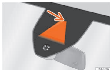
Fig. 266 Nel parabrezza: area del campo visivo della telecamera del dispositivo di assistenza per il mantenimento della corsia.
