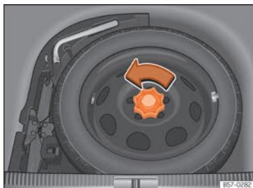
Fig. 310 Ruotino di scorta: piano di carico sollevato.
