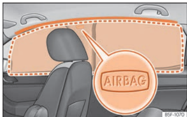
Fig. 34 Posizione degli airbag per la testa.
