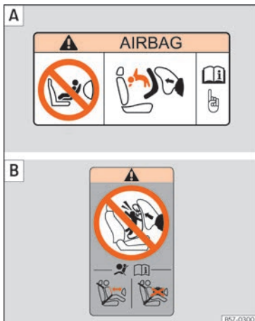
Fig. 37 Adesivi dell'airbag - versione 2: sull'aletta parasole lato passeggero [A] e nel telaio posteriore della porta del passeggero [B].
