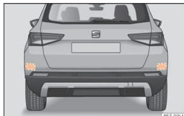
Fig. 272 Vista complesso posteriore del veicolo: zone dei sensori radar.
