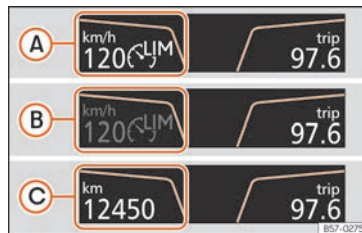
Fig. 251 Sul display del quadro strumenti: indicazioni dello stato del limitatore di velocità.
