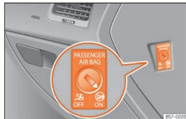
Fig. 28 Commutatore dell'airbag frontale del passeggero.
