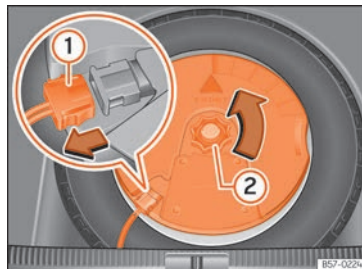
Fig. 311 Nel bagagliaio: smontare il subwoofer.
