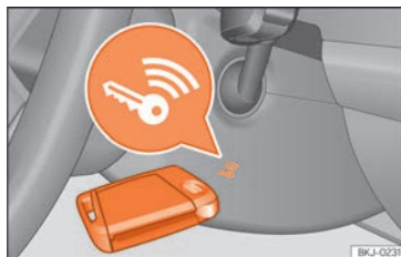
Fig. 242 A destra del piantone dello sterzo: avviamento di emergenza.
