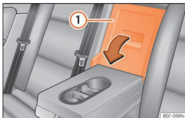
Fig. 174 Sullo schienale del sedile posteriore: apertura della sponda.
