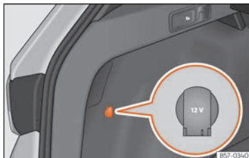
Fig. 169 Particolare del rivestimento laterale del bagagliaio: presa elettrica da 12 Volt.
