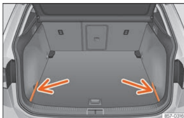
Fig. 172 Nel bagagliaio: coperchi per la riposizione del pianale.
