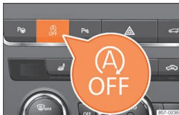
Fig. 248 Console centrale: tasto del sistema Start/Stop.
