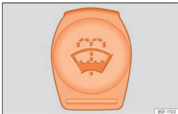
Fig. 66 Nel vano motore: tappo del serbatoio dei tergicristalli.
