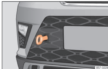
Fig. 80 Paraurti anteriore destro: occhiello di traino avvitato.
