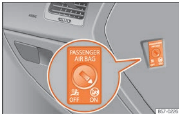
Fig. 98 Interruttore a chiave per l'attivazione e la disattivazione dell'airbag del passeggero.
