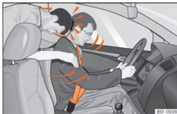
Fig. 95 Se non indossa la cintura, il passeggero seduto sul sedile posteriore viene scagliato in avanti, colpendo il conducente (che invece indossa la cintura)
