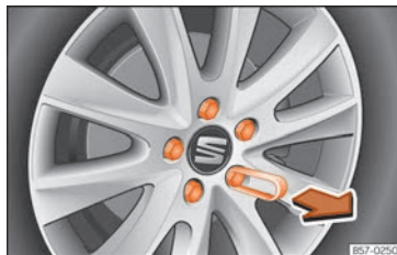
Fig. 75 Ruota: viti della ruota con tappi.
