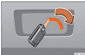
Fig. 11 Particolare del bagagliaio: sblocco di emergenza.
