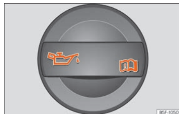
Fig. 63 Vano motore: tappo del bocchettone di rifornimento dell'olio motore.
