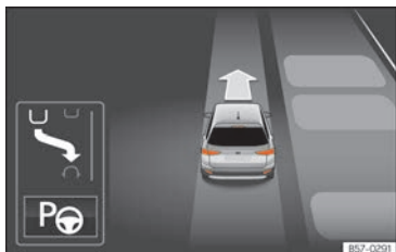
Fig. 281 Sul display del quadro strumenti: visualizzazione dell'assistente di parcheggio con visualizzazione ridotta.
