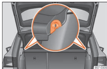
Fig. 171 Nel bagagliaio: smontare e montare il ripiano.
