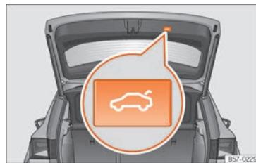
Fig. 9 Portellone posteriore: tasto per chiudere il portellone.
