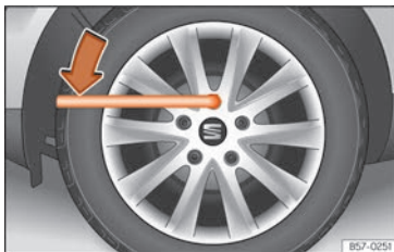
Fig. 77 Ruota: allentare le viti della ruota.
