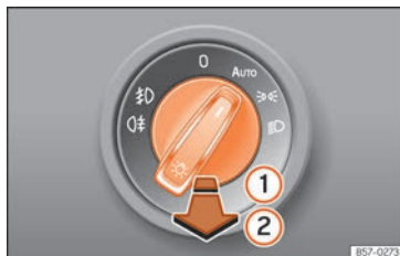
Fig. 152 Plancia portastrumenti: interruttore delle luci.
