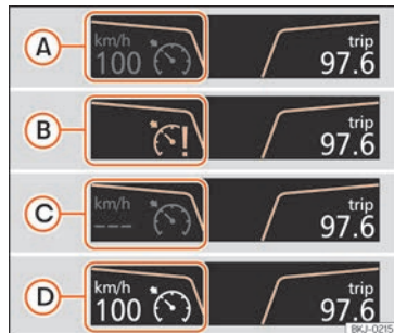
Fig. 250 Display del quadro strumenti: indicazioni sullo stato del GRA.
