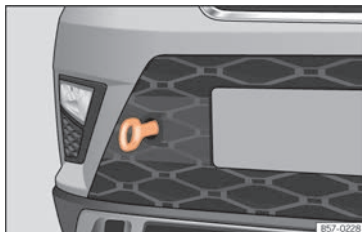
Fig. 102 Sul lato destro del paraurti anteriore: occhiello di traino avvitato.
