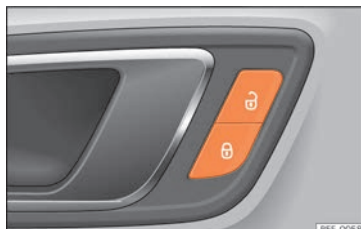
Fig. 5 Porta del conducente: interruttore della chiusura centralizzata.
