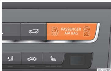
Fig. 99 Plancia portastrumenti: spia della disattivazione degli airbag del passeggero anteriore.
