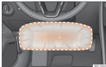
Fig. 31 Sul lato del conducente: raggio d'azione dell'airbag per le ginocchia.
