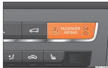
Fig. 29 Plancia portastrumenti: spia della disattivazione degli airbag del passeggero anteriore.
