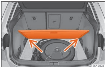
Fig. 181 Piano variabile del bagagliaio: posizione inclinata.
