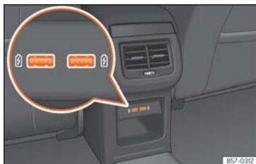
Fig. 237 Parte posteriore della console centrale: connettori USB.
