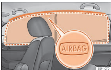
Fig. 23 Posizione degli airbag per la testa.
