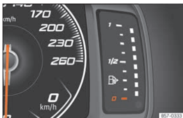
Fig. 76 Quadro strumenti digitale: indicatore del livello del carburante.
