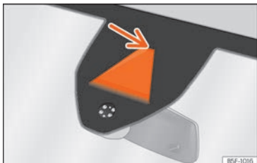
Fig. 269 Nel parabrezza: area del campo visivo della telecamera del dispositivo di assistenza per il mantenimento della corsia.
