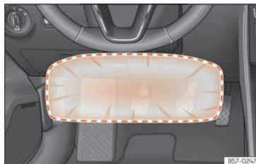
Fig. 20 Sul lato conducente: raggio d'azione dell'airbag per le ginocchia.
