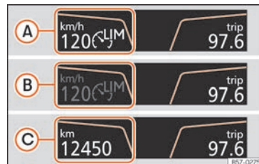
Fig. 253 Sul display del quadro strumenti: indicazioni dello stato del limitatore di velocità.
