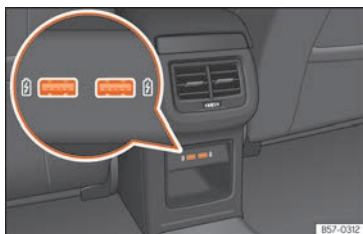
Fig. 235 Parte posteriore della console centrale: connettori USB.
