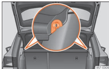
Fig. 133 Nel bagagliaio: smontare e montare il ripiano.
