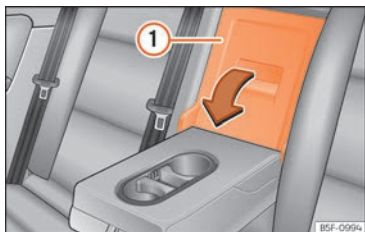
Fig. 142 Sullo schienale del sedile posteriore: apertura della sponda.
