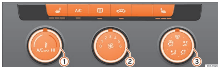
Fig. 154 Sulla console centrale: Comandi del climatizzatore manuale.
