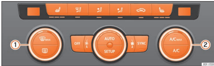
Fig. 153 Sulla console centrale: comandi del Climatronic.
