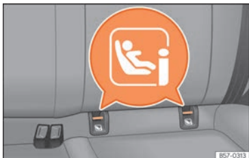
Fig. 28 Sedile posteriore: occhielli di fissaggio ISOFIX/iSize.
