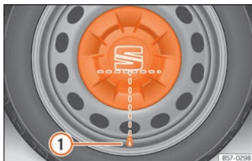
Fig. 35 Posizionamento corretto del copricerchio centrale per cerchi in acciaio.
