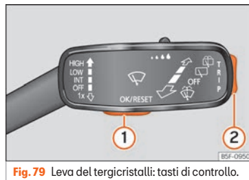
Fig.79 Leva del tergicristalli: tasti di controllo.
