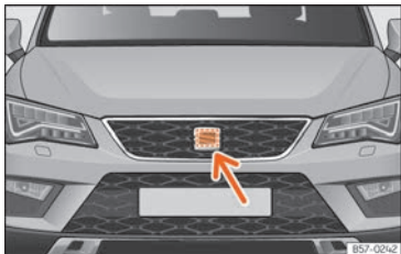
Fig. 257 Nella parte anteriore, dietro allo stemma SEAT, è montato un sensore radar »» fig. 257.
