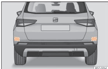
Fig. 275 Vista posteriore del veicolo: zone dei sensori radar.
