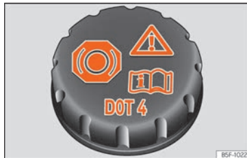
Fig. 315 Vano motore: tappo del serbatoio del liquido dei freni.
