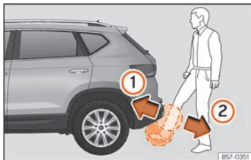
Fig. 103 Portellone del bagagliaio con apertura controllata da sensore (Easy Open).
