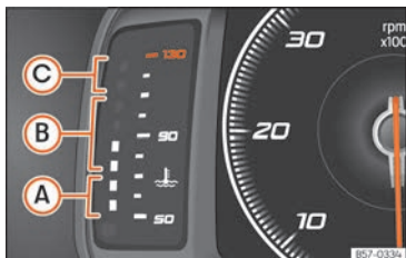
Fig. 78 Quadro strumenti digitale: indicatore della temperatura del liquido di raffreddamento.
