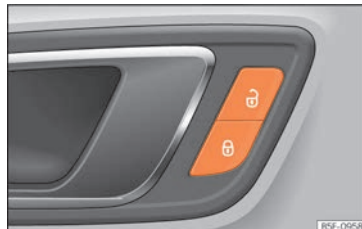
Fig. 92 Porta del conducente: interruttore della chiusura centralizzata.
