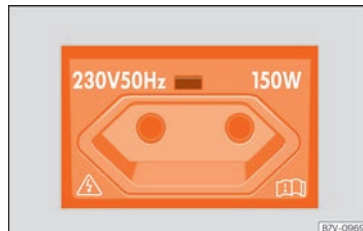
Fig. 151 Sul lato sinistro del bagagliaio: presa elettrica da 230 Volt.
