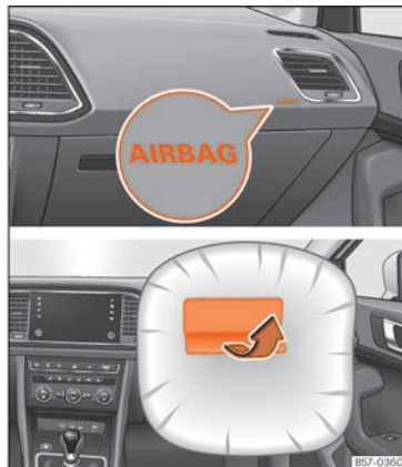
Fig. 16 Airbag del passeggero sul cruscotto.
