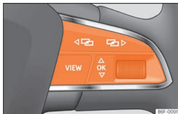
Fig. 80 Lato destro del volante multifunzione: tasti per l'utilizzo dei menu e delle indicazioni informative del quadro strumenti.
