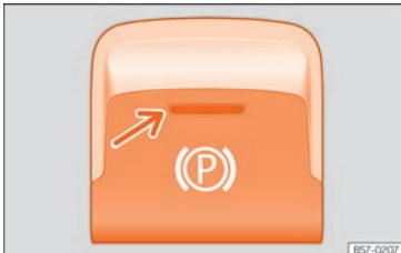
Fig. 279 Nella parte inferiore della console centrale: tasto del freno di stazionamento elettronico.
