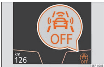
Fig. 258 Sul display del quadro strumenti: indicazione di Front Assist disattivato.
