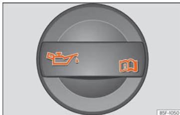
Fig. 312 Vano motore: tappo del bocchettone di rifornimento dell'olio motore.
