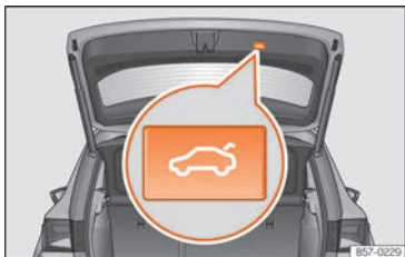
Fig. 101 Portellone posteriore: tasto per chiudere il portellone.
