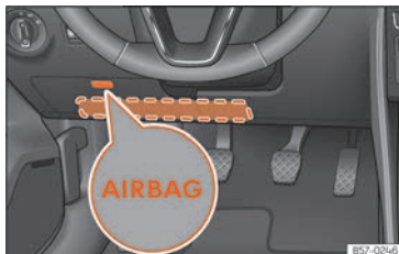
Fig. 19 Sul lato conducente: posizione dell'airbag per le ginocchia.
