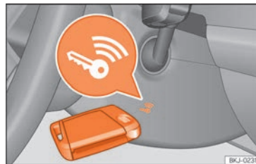
Fig. 240 A destra del piantone dello sterzo: avviamento di emergenza.
