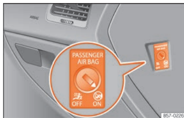
Fig. 17 Interruttore a chiave per l'attivazione e la disattivazione dell'airbag del passeggero.
