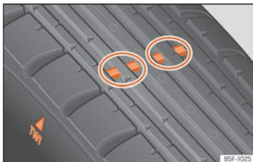
Fig. 318 Spessore del battistrada dello pneumatico: indicatori di usura.
