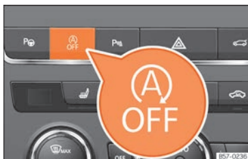
Fig. 241 Console centrale: tasto del sistema Start/Stop.
