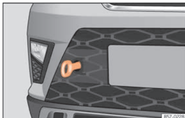
Fig. 48 Sul lato destro del paraurti anteriore: occhiello di traino avvitato.
