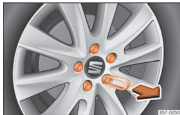
Fig. 36 Ruota: viti della ruota con tappi.
