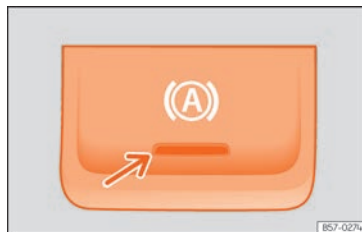
Fig. 280 Nella parte inferiore della console centrale: tasto della funzione Auto Hold.
