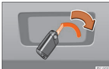
Fig. 105 Particolare del bagagliaio: sblocco di emergenza.
