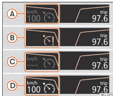
Fig. 251 Display del quadro strumenti: indicazioni sullo stato del GRA.
