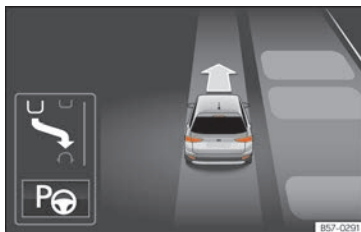
Fig. 283 Sul display del quadro strumenti: visualizzazione dell'assistente di parcheggio con visualizzazione ridotta.
