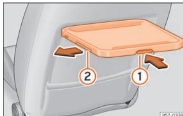
Rys. 147 Lewy przedni fotel: składany stół z uchwytem na napoje.
