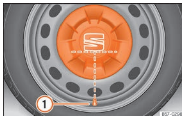
Rys. 35 Prawidłowo założona ostona piasty na feldze stalowej.
