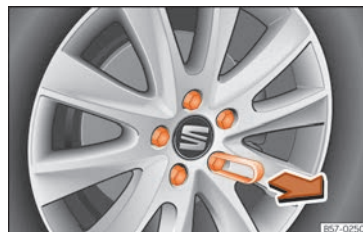
Rys. 36 Koło: śruby kół z nasadkami.
