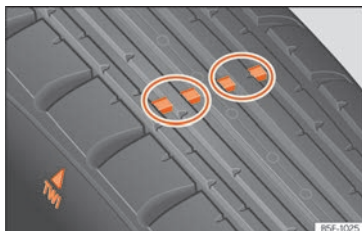
Rys. 318 Profil opony: wskaźniki zużycia bieżnika.
