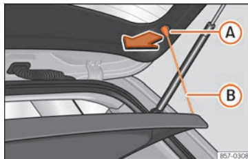
Rys. 132 W bagażniku: zdejmowanie i zakładanie tylnej półki.
