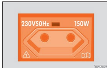
Rys. 151 Po lewej stronie bagażnika: Gniazdo zasilania 230 V.
