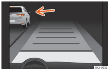
Rys. 266 Na wyświetlaczu tablicy rozdzielczej: ACC aktywny, wykryto pojazd na pasie zewnętrznym
