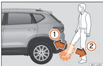
Rys. 103 Pokrywa bagażnika z otwieraniem sterowanym za pomocą czujnika (Easy Open).
