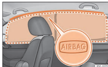
Rys. 23 Umieszczenie poduszek powietrznych chroniących głowę.
