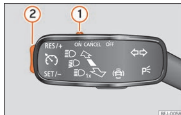
Rys. 252 Na dźwigni kierunkowskazów: przełącznik i przyciski do obsługi tempomatu.
