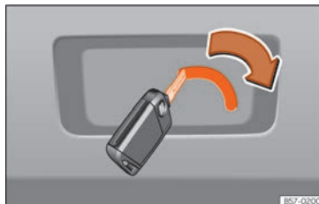
Rys. 105 Szczegół bagażnika: awaryjne odryglowanie
