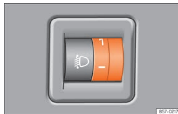
Rys. 116 Obok kolumny kierownicy: regulacja zasięgu reflektorów.
