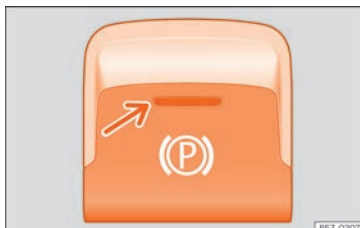
Rys. 279 W dolnej części konsoli środkowej: elektroniczny hamulec postojowy
