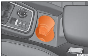
Rys. 149 Konsola środkowa: przednie uchwyty na napoje.
