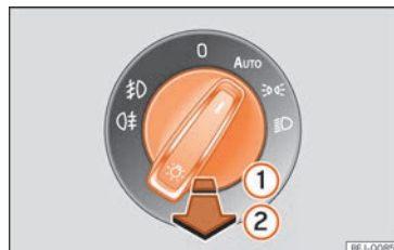
Rys. 113 Deska rozdzielcza: przetłącznik świateł.
