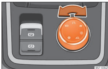
Rys. 249 Konsola środkowa: Przycisk Trybu Jazdy.
