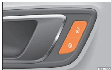
Rys. 92 Drzwi kierowcy: przycisk centralnego zamka.
