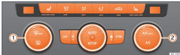
Rys. 153 W konsoli środkowej: przełączniki do sterowania klimatyzacją Climatronic.
