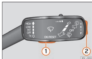
Rys. 79 Dźwignia przetłącznika wycieraczek: przyciski.
