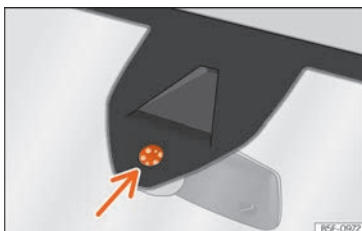
Rys. 120 Powierzchnia aktywna czujnika deszczu
