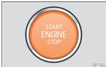
Rys. 239 W dolnej części konsoli środkowej: przycisk rozrusznika.
