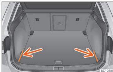
Rys. 134 W bagażniku: osłony do schowania tylnej półki.
