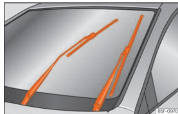
Rys. 42 Wycieraczki w położeniu serwisowym.
