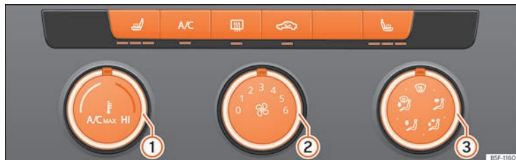
Rys. 154 Na konsoli środkowej: Ręczna regulacja klimatyzacji.
