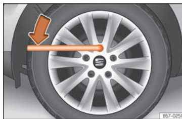
Rys. 38 Zmiana koła: poluzować śruby koła.
