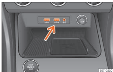
Fig. 234 Centre console: USB/AUX-IN input.
