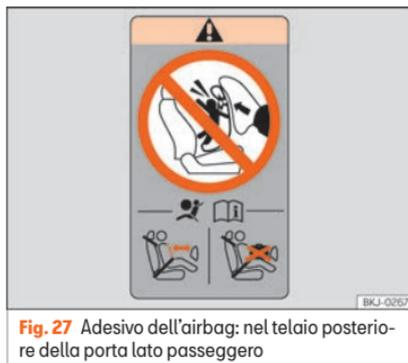
**Fig. 27** Adesivo dell'airbag: nel telaio posteriore della porta lato passeggero
