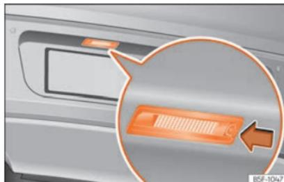
**Fig. 65** Nel paraurti posteriore: luce della targa.
