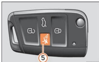
**Fig. 88** Chiave del veicolo con pulsante di allarme.
