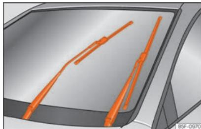
**Fig. 42** Tergicristalli in posizione di manutenzione.
