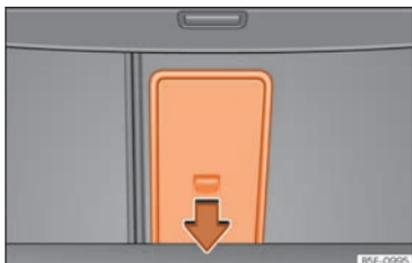
**Fig. 143** Nel bagagliaio: apertura della sponda.
