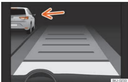
**Fig. 266** Sul display del quadro strumenti: ACC attivo, veicolo rilevato sulla sinistra
