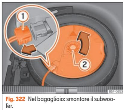
**Fig. 322** Nel bagagliaio: smontare il subwoofer.
