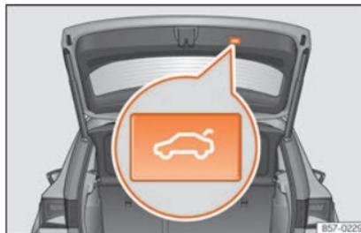
**Fig. 101** Portellone posteriore: tasto per chiudere il portellone.
