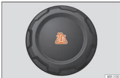
**Fig. 314** Vano motore: tappo del serbatoio di compensazione del liquido di raffreddamento.
