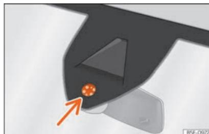
**Fig. 120** Superficie sensibile del sensore pioggia.
