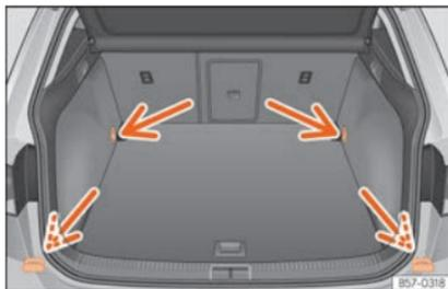
**Fig. 138** Nel bagagliaio: occhielli di ancoraggio.
