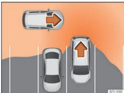
**Fig. 278** Rappresentazione schematica dell'assistente di uscita dal parcheggio: zona vigilata attorno al veicolo che sta uscendo dal parcheggio.
