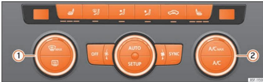
**Fig. 153** Sulla console centrale: comandi del Climatronic.
