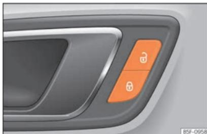
**Fig. 92** Porta del conducente: interruttore della chiusura centralizzata.
