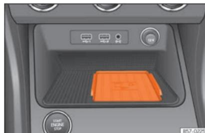
Fig. 237 Sulla console centrale: alloggiamento per il collegamento del telefono cellulare.
