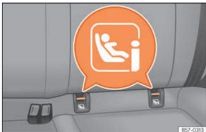
**Fig. 28** Sedile posteriore: occhielli di fissaggio ISOFIX/iSize.
