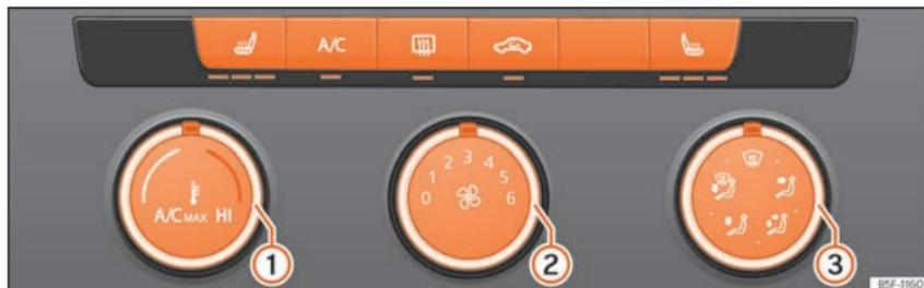
**Fig. 154** Sulla console centrale: Comandi del climatizzatore manuale.
