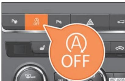
**Fig. 241** Console centrale: tasto del sistema Start/Stop.
