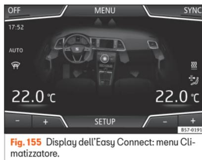
**Fig. 155** Display dell'Easy Connect: menu Climatizzatore.
