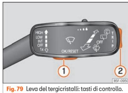
**Fig.79** Leva del tergicristalli: tasti di controllo.
