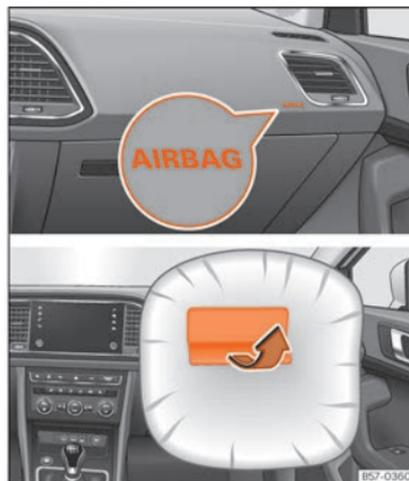
**Fig. 16** Airbag del passeggero sul cruscotto.
