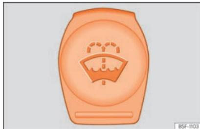
**Fig. 316** Nel vano motore: tappo del serbatoio del tergicristalli.
