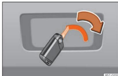
**Fig. 105** Particolare del bagagliaio: sblocco di emergenza.
