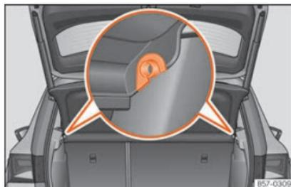
**Fig. 133** Nel bagagliaio: smontare e montare il ripiano.
