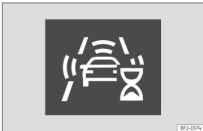
**Fig. 259** Sul display del quadro strumenti: indicazione dell'autocalibrazione iniziale del sistema.
