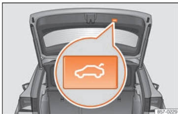
Rys. 101 Pokrywa bagażnika: przycisk do otwierania i zamykania klapy bagażnika.
