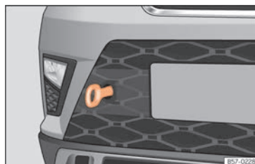
Rys. 48 Z prawej strony zderzaka przedniego: pierścień holowniczy na miejscu.
