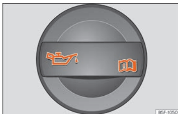
Rys. 312 W komorze silnika: korek wlewu oleju silnikowego.
