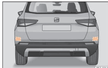
Rys. 275 Widok samochodu z tyłu: strefy działania czujników radarowych.
