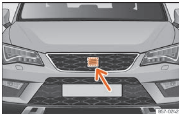
Rys. 263 Z przodu za znacznikiem SEAT-a: czujniki radarowe.
