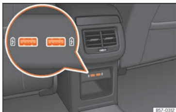
Rys. 235 Z tyłu konsoli środkowej: złącza USB.
