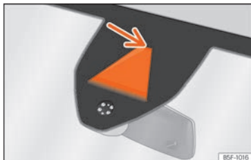
Rys. 269 Na przedniej szybie: pole widzenia Asystenta pasa ruchu.
