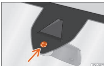
Rys. 120 Powierzchnia aktywna czujnika deszczu
