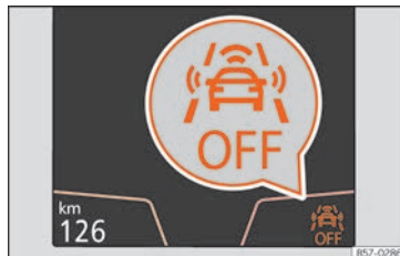
Rys. 258 Na wyświetlaczu tablicy rozdzielczej: Front Assist wyłączony.
