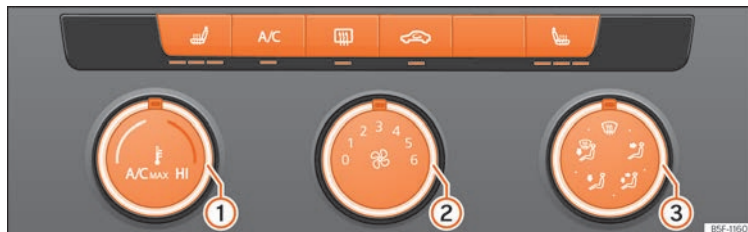
Rys. 154 Na konsoli środkowej: ręczna regulacja klimatyzacji.
