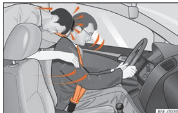
Rys. 9 Pasażer na tylnym siedzeniu nie posiadający zapiętych pasów bezpieczeństwa zostaje gwałtownie wyrzucony do przodu, uderzając kierowcę, który ma zapięty pas.
