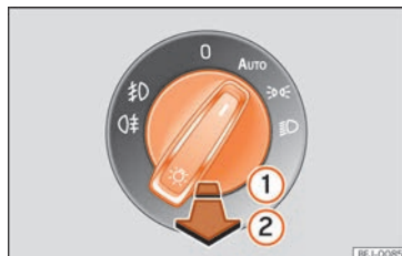
Rys. 113 Deska rozdzielcza: przetwornik świateł.
