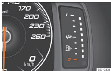
Rys.76 Cyfrowa tablica rozdzielcza: wskaźnik paliwa.
