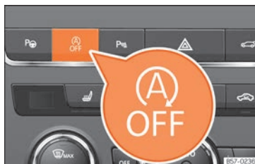
Rys. 241 Konsola środkowa: przycisk systemu Start-Stop.
