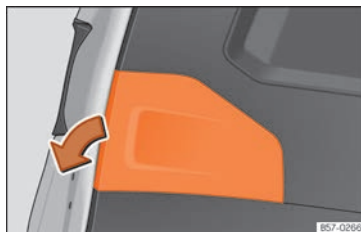
Rys. 63 Otwarta pokrywa bagażnika: zdjęcie osłony.
