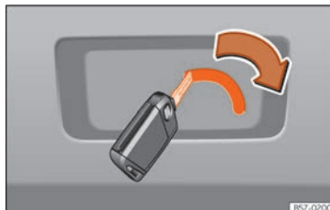
Rys. 105 Szczegół bagażnika: awaryjne odryglowanie
