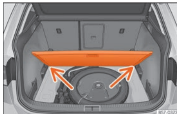
Rys. 137 Regulowana podłoga bagażnika: pozycja nachylona.
