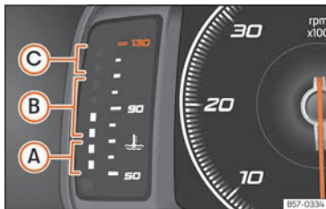
Rys. 78 Cyfrowa tablica rozdzielcza: wskaźnik temperatury płynu chłodzącego silnika.
