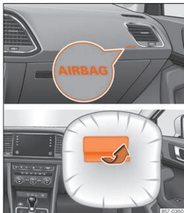
Rys. 16 Czołowa poduszka powietrzna pasażera umieszczona w desce rozdzielczej.
