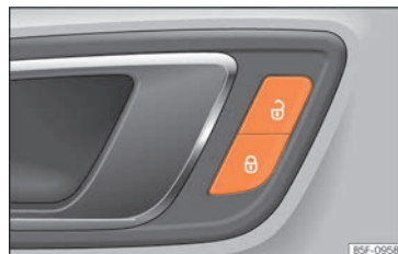
Rys. 92 Drzwi kierowcy: przycisk centralnego zamka.
