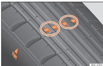
Rys. 318 Profil opony: wskaźniki zużycia bieżnika.
