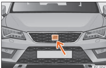
Rys. 257 Z przodu za znacznikiem SEAT-a: czujnik radarowy.: czujniki radarowe.
