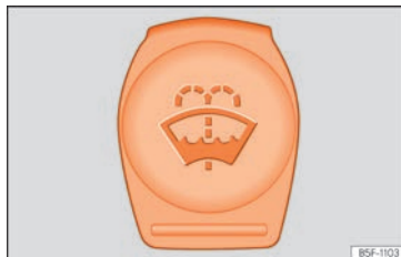
Rys. 316 W komorze silnika: korek zbiornika płynu do spryskiwaczy.
