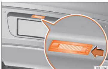
Rys. 65 W tylnym zderzaku: podświetlenie tablicy rejestracyjnej.
