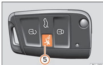
Rys. 88 Kluczyk samochodowy z przyciskiem alarmu.
