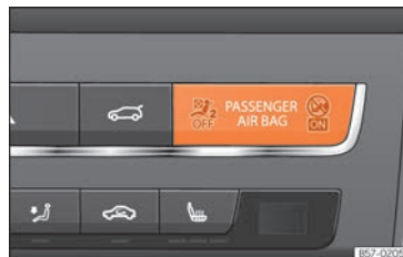
Rys. 18 Deska rozdzielcza: lampka kontrolna wyłączenia przedniej poduszki powietrznej pasażera.
