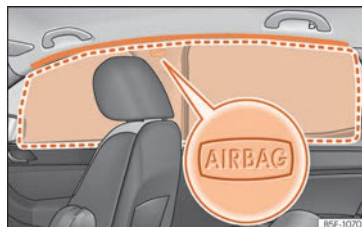
Rys. 23 Umieszczenie poduszek powietrznych chroniących głowę.
