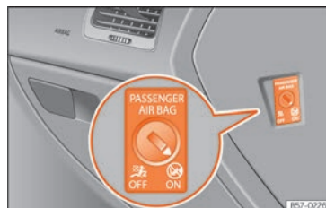
Rys. 17 Przetątnik czołowej poduszki powietrznej pasażera.
