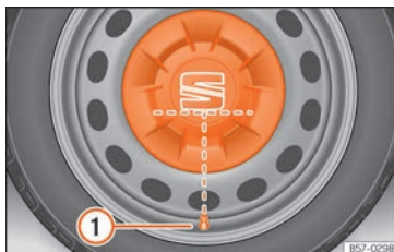
Rys. 35 Prawidłowo założona ostona piasty na feldze stalowej.
