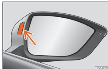
Rys. 190 Lampka kontrolna pojazdu systemu ostrzegania o zjeżdżaniu z pasa ruchu.
