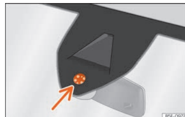
Rys. 147 Czujnik wilgotności i temperatury przedniej szyby
