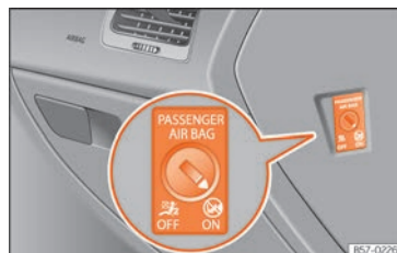
Rys. 16 Przetątnik czołowej poduszki powietrznej pasażera.
