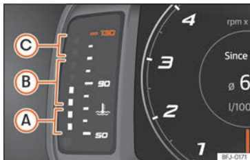
Rys. 74 Cyfrowa tablica przyrządów: wskaźnik temperatury płynu chłodzącego silnika.
