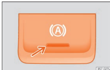
Rys. 195 W dolnej części konsoli środkowej: przycisk funkcji Auto Hold.
