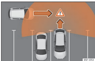
Rys. 193 Diagram przedstawiający działanie systemu asystenta wyjazdu: obszar monitorowany wokół pojazdu wyjeżdżającego z miejsca parkowania.
