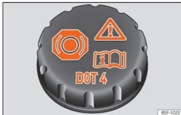
Rys. 226 Komora silnika: korek zbiornika płynu hamulcowego.
