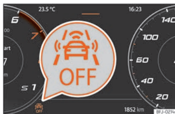
Rys. 178 Na wyświetlaczu tablicy rozdzielczej: Front Assist wyłączony.
