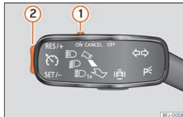
Rys. 174 Na dźwigni kierunkowskazów: przełącznik i przyciski do obsługi tempomatu.
