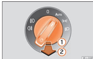
Rys. 108 Tablica rozdzielcza: przełącznik światła.
