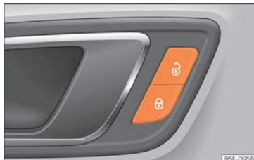
Rys. 90 Drzwi kierowcy: przycisk centralnego zamka.
