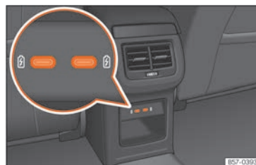
Rys. 156 Z tyłu konsoli środkowej: gniazda USB z funkcją gniazda zasilania.
