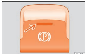
Rys. 194 W dolnej części konsoli środkowej: elektroniczny hamulec postojowy
