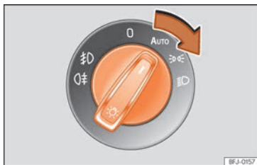
Rys. 107 Tablica rozdzielcza: przełącznik świateł.
