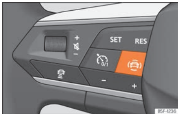
Rys. 78 Lewa strona kierownicy wielofunkcyjnej: przycisk systemów wspomagania kierowcy (w zależności od wersji).
