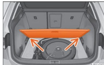
Rys. 131 Regulowana podłoga bagażnika: pozycja nachylona.
