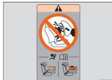
Rys. 25 Naklejka z symbolem poduszki powietrznej: w tylnej części ramy drzwi po stronie pasażera
