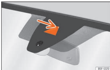
Rys. 169 Na przedniej szybie: pole widzenia Asystenta pasa ruchu.
