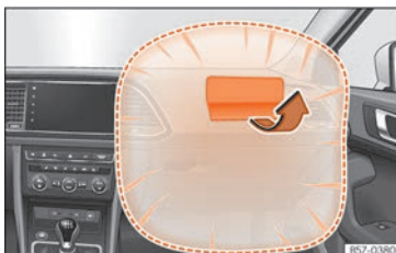
Rys. 15 Czołowa poduszka powietrzna pasażera umieszczona w desce rozdzielczej.
