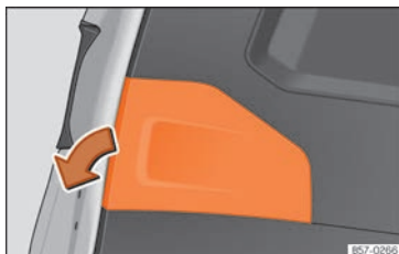
Rys. 61 Otwieranie kłapy bagażnika: zdjęcie osłony.
