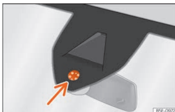
Rys. 114 Powierzchnia aktywna czujnika deszczu
