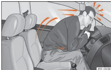
Rys. 8 Kierowca nie posiadający zapiętych pasów bezpieczeństwa zostaje wyrzucony gwałtownie do przodu.
