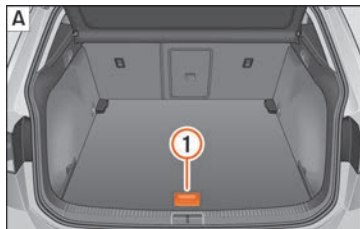
Rys. 131 Regulowana podłoga bagażnika: pozycja nachylona.
