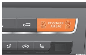
Rys. 17 Tablica rozdzielcza: lampka kontrolna wyłączenia przedniej poduszki powietrznej pasażera.
