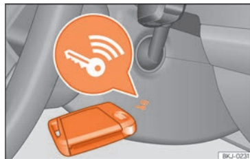
Rys. 159 Po prawej stronie kolumny kierownicy: rozruch awaryjny.
