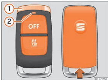
Rys. 148 Ogrzewanie pomocnicze: pilot radiowy zdalnego sterowania.
