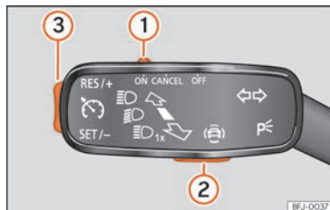
Rys. 176 Na dźwigni kierunkowskazów: przyciski do obsługi ogranicznika prędkości.
