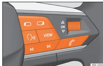
Rys. 75 Prawa strona kierownicy wielofunkcyjnej: przyciski do menu i wskazań informacyjnych na tablicy przyrządów.
