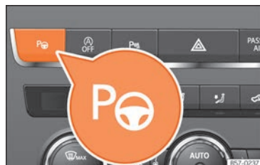
Rys. 196 W górnej części konsoli środkowej: przycisk włączania i wyłączenia układu wspomaganie parkowania (Park Assist).
