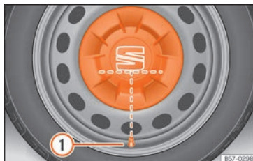
Rys. 33 Prawidłowo założona ostona piasty na feldze stalowej.
