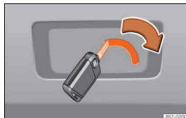
Rys. 102 Szczegół bagażnika: awaryjne odryglowanie
