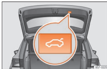
Rys. 98 Klapa bagażnika: przycisk do zamykania klapy bagażnika.
