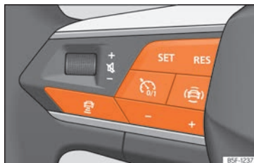
Rys. 180 Na kierownicy wielofunkcyjnej: przyciski do obsługi aktywnego tempomatu
