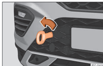
Rys. 46 Z prawej strony zderzaka przedniego: pierścień holowniczy na miejscu.
