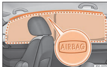
Rys. 22 Umieszczenie poduszek powietrznych chroniących głowę.
