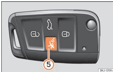
Rys. 86 Kluczyk samochodowy z przyciskiem alarmu.
