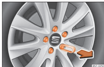
Rys. 34 Koło: śruby kół z nasadkami.
