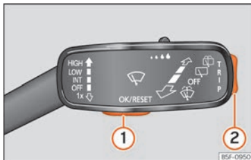
Rys. 76 Dźwignia przycisków wycieraczek: przyciski.
