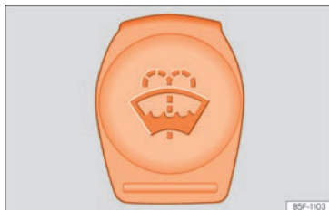
Rys. 227 W komorze silnika: korek zbiornika płynu do spryskiwaczy.
