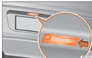
Rys. 63 W tylnym zderzaku: podświetlenie tablicy rejestracyjnej.
