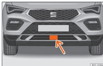
Rys. 167 Na przednim zderzaku: czujniki radarowe.
