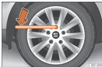
Rys. 36 Zmiana koła: poluzować śruby koła.
