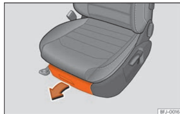
Rys. 141 Wysuwany schowek pod przednim siedzeniem
