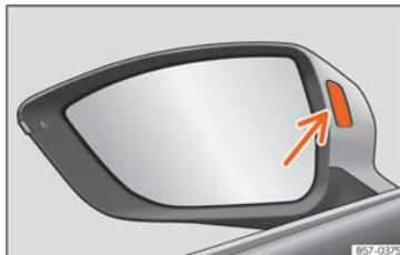
Rys. 189 Lampka kontrolna pojazdu systemu ostrzegania o zjeżdżaniu z pasa ruchu.
