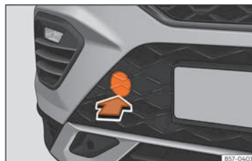
Rys. 45 Z prawej strony zderzaka przedniego: zdjąć osłonę.
