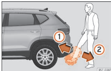
Rys. 100 Klapa bagażnika z otwieraniem sterowanym za pomocą czujnika (Easy Open).
