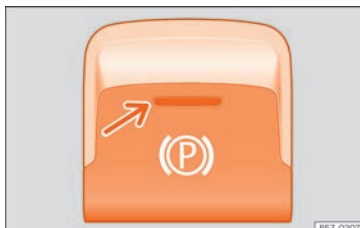
Rys. 193 W dolnej części konsoli środkowej: elektroniczny hamulec postojowy
