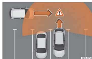
Rys. 192 Diagram przedstawiający działanie systemu monitorowania ruchu poprzecznego przy cofaniu: obszar monitorowany wokół pojazdu wyjeżdżającego z miejsca parkowania.
