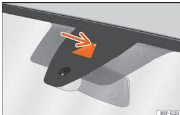
Rys. 159 Na przedniej szybie: pole widzenia Asystenta pasa ruchu.
