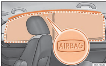
Rys. 22 Umieszczenie poduszek powietrznych chroniących głowę.
