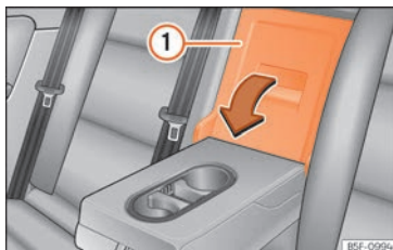
Rys. 125 W oparciu tylnego siedzenia: otwieranie przejścia do bagażnika.
