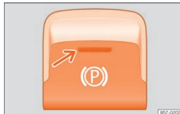
Rys. 182 W dolnej części konsoli środkowej: elektroniczny hamulec postojowy
