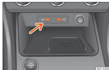
Rys. 146 Konsola środkowa: gniazdo USB.
