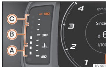
Rys. 62 Cyfrowa tablica przyrządów: wskaźnik temperatury płynu chłodzącego silnika.
