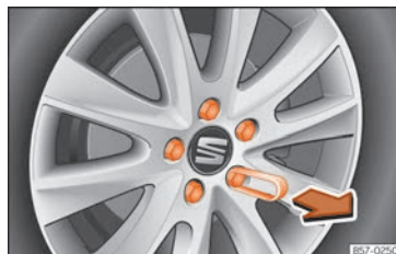
Rys. 34 Koło: śruby kół z nasadkami.
