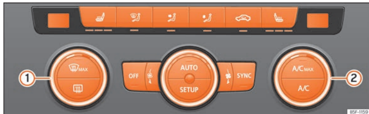
Rys. 134 W konsoli środkowej: przełączniki do sterowania klimatyzacją Climatronic.
