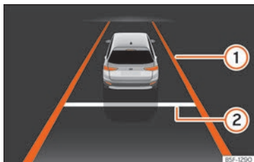
Rys. 174 Na wyświetlaczu tablicy rozdzielczej: sygnalizacja z aktywną regulacją.
