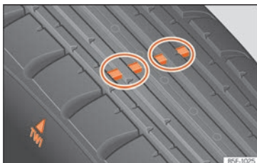
Rys. 219 Profil opony: wskaźniki zużycia bieżnika.
