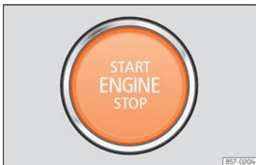
Rys. 148 W dolnej części konsoli środkowej: przycisk rozrusznika.
