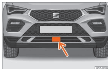
Rys. 157 Na przednim zderzaku: czujniki radarowe.
