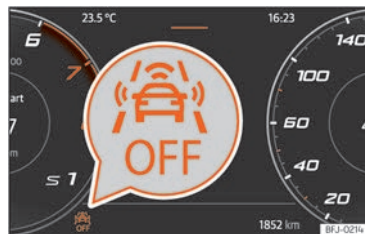
Rys. 166 Na wyświetlaczu tablicy rozdzielczej: System Front Assist wyłączony.
