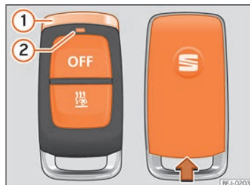
Rys. 138 Ogrzewanie pomocnicze: pilot radiowy zdalnego sterowania.
