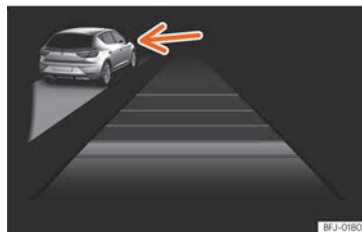
Rys. 170 Na wyświetlaczu tablicy rozdzielczej: włączony ACC, wykryto pojazd na lewym pasie
