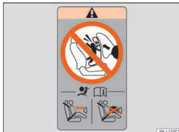
Rys. 25 Naklejka z symbolem poduszki powietrznej: w tylnej części ramy drzwi po stronie pasażera
