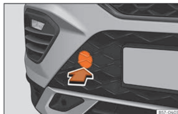
Rys. 45 Z prawej strony zderzaka przedniego: zdjąć osłonę.
