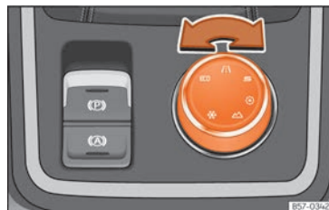
Rys. 156 Konsola środkowa: Przycisk Trybu jazdy.
