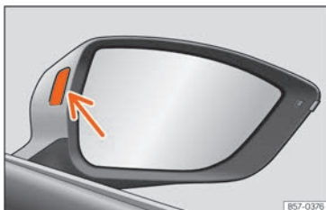
Rys. 178 Lampka kontrolna pojazdu systemu ostrzegania o zjeżdżaniu z pasa ruchu.
