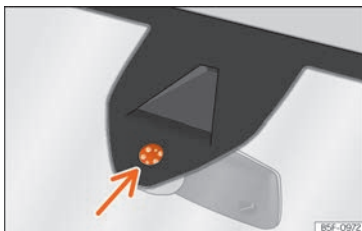
Rys. 103 Powierzchnia aktywna czujnika deszczu
