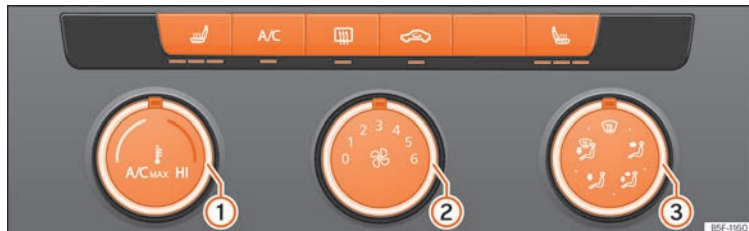
Rys. 135 W konsoli środkowej: Ręczna regulacja klimatyzacji.
