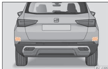
Rys. 160 Widok pojazdu z tyłu: strefy działania czujników radarowych.
