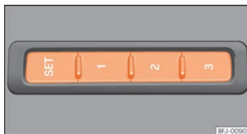
Rys. 111 Po zewnętrznej stronie siedzenia kierowcy: przyciski pamięci
