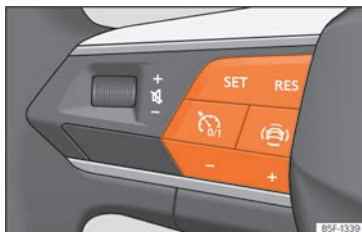
Rys. 163 Na kierownicy wielofunkcyjnej: przyciski do obsługi ogranicznika prędkości.
