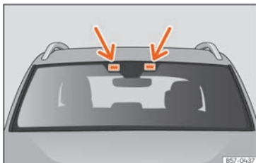
Rys. 137 Miejsca do umieszczenia akcesoriów elektronicznych
