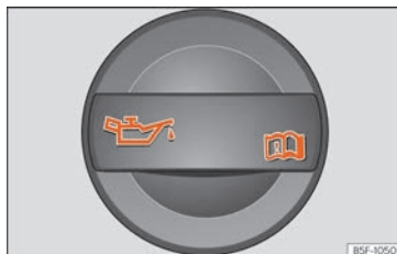
Rys. 213 W komorze silnika: Korek wlewu oleju silnikowego.
