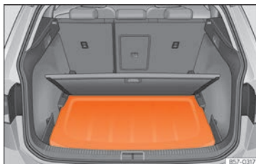
Rys. 118 W bagażniku: wkładanie tylnej półki.
