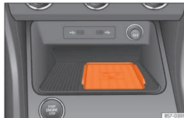
Rys. 145 W konsoli środkowej: miejsce do podłączenia telefonu komórkowego.
