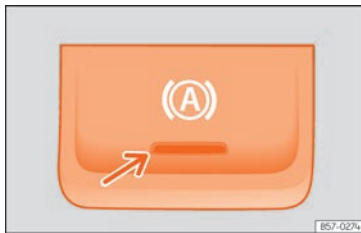
Rys. 183 W dolnej części konsoli środkowej: przycisk funkcyjny Auto Hold.
