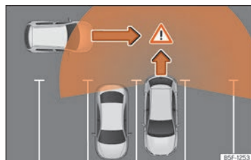
Rys. 181 Diagram przedstawiający działanie systemu monitorowania ruchu poprzecznego przy cofaniu: obszar monitorowany wokół pojazdu wyjeżdżającego z miejsca parkowania.
