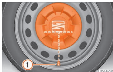
Rys. 33 Prawidłowo założona ostona piasty na feldze stalowej.
