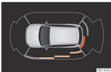
Rys. 192 Widok Asystenta parkowania na ekranie systemu Infotainment.
