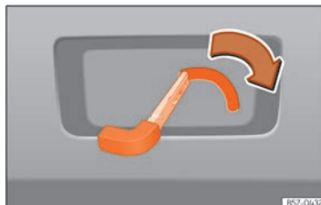
Rys. 91 Szczegół bagażnika: awaryjne odryglowanie
