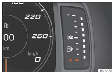
Rys. 60 Cyfrowa tablica przyrządów: wskaźnik paliwa.
