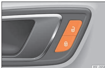
Rys. 79 Drzwi kierowcy: przycisk centralnego zamka.
