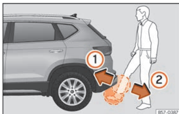
Rys. 89 Kłapa bagażnika z otwieraniem sterowanym za pomocą czujnika (Easy Open).
