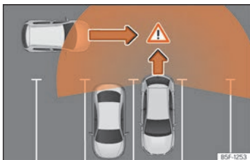
Rys. 182 Diagram przedstawiający działanie systemu monitorowania ruchu poprzecznego przy cofaniu: obszar monitorowany wokół pojazdu wyjeżdżającego z miejsca parkowania.
