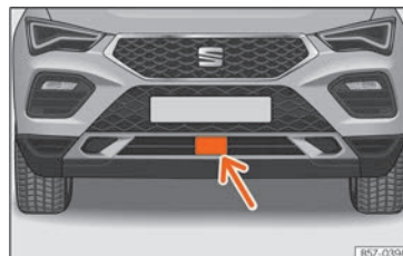
Rys. 158 Na przednim zderzaku: czujniki radarowe.
