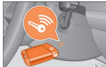
Rys. 150 Po prawej stronie kolumny kierownicy: rozruch awaryjny.
