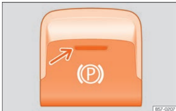
Rys. 183 W dolnej części konsoli środkowej: elektroniczny hamulec postojowy
