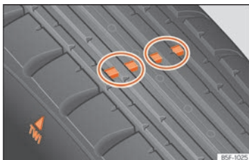
Rys. 220 Profil opony: wskaźniki zużycia bieżnika.
