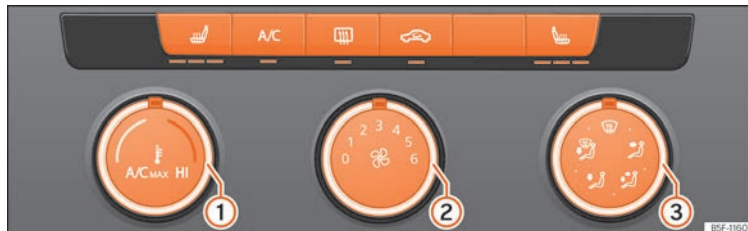
Rys. 136 W konsoli środkowej: Ręczna regulacja klimatyzacji.
