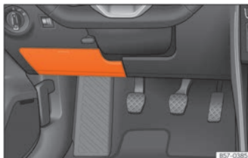
Rys. 49 Pojazd z lewostronnym układem kierowniczym: pokrywa skrzynki bezpieczników pod deską rozdzielczą po stronie kierowcy
