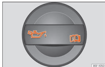
Rys. 209 Osłona korka wlewu oleju w komorze silnika
