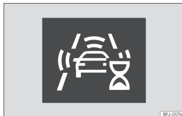
Rys. 121 Na ekranie zestawu wskaźników: wskazanie wstępnej auto-kalibracji systemu.
