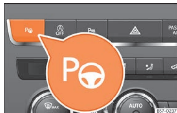
Rys. 137 Górna część konsoli środkowej: przycisk do włączania układu wspomagania parkowania (Park Assist).
