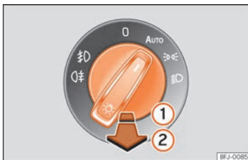
Rys. 83 Tablica przyrządów: przetłącznik światła.
