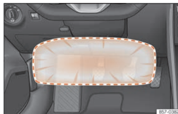
Rys. 35 Po stronie kierowcy: promień działania poduszki powietrznej chroniącej kolano.
