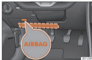
Rys. 34 Po stronie kierowcy: umiejscowienie poduszki powietrznej chroniącej kolano.
