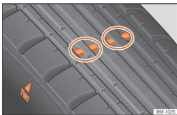
Rys. 212 Profil opony: wskaźniki zużycia bieżnika.
