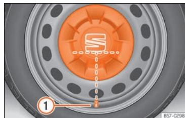
Rys. 216 Prawidłowo założona ostona piasty na feldze stalowej.
