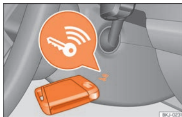
Rys. 97 Po prawej stronie kolumny kierownicy: rozruch awaryjny.
