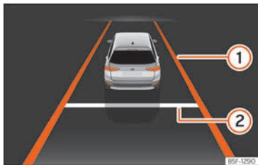
Rys. 124 Na wyświetlaczu zestawu wskaźników: wskazanie aktywnej regulacji (schematycznie).
