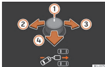
Rys. 147 Obrótowe sterowanie zewnętrznym lusterkiem tylnym: regulacja kąta przyczepy.
