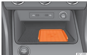
Rys. 163 Konsola środkowa: slot do podłączenia telefonu komórkowego.
