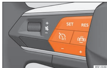
Rys. 114 Na kierownicy wielofunkcyjnej: przyciski do sterowania ogranicznikiem prędkości.
