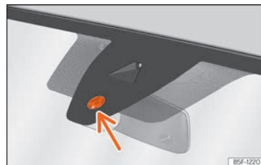
Rys. 88 Powierzchnia aktywna czujnika deszczu
