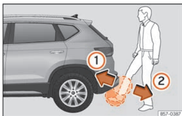
Rys. 62 Kłapa bagażnika z otwieraniem sterowanym za pomocą czujnika (Easy Open).
