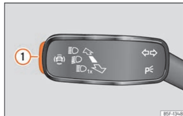
Rys. 105 Na dźwigni kierunkowskazów i światła drogowych: klawisz systemów wspomagania kierowcy (w zależności od wersji).
