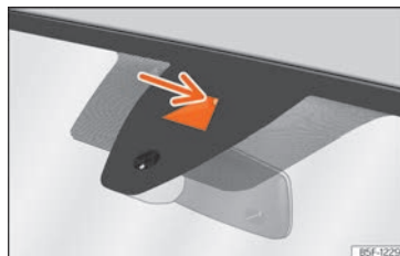
Rys. 109 Na przedniej szybie: pole widzenia kamery Asystenta pasa ruchu.
