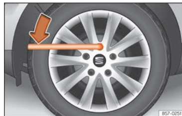
Rys. 219 Wymiana opon: luzowanie śrub koła.
