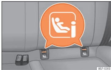
Rys. 39 Tyłne siedzenie: lokalizacja uchwytów mocujących systemu ISOFIX lub i-Size.
