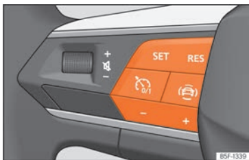
Rys. 113 Na kierownicy wielofunkcyjnej: przyciski obsługi tempomatu.
