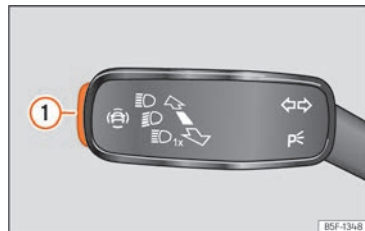
Rys. 106 Na dźwigni kierunkowskazów i światła drogowych: klawisz systemów wspomagania kierowcy (w zależności od wersji).
