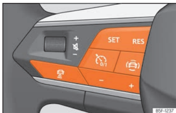
Rys. 117 Na kierownicy wielofunkcyjnej: przyciski do obsługi tempomatu ACC.
