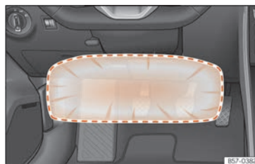
Rys. 35 Po stronie kierowcy: promień działania poduszki powietrznej chroniącej kolana.
