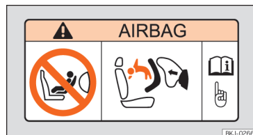
Rys. 37 Naklejka z symbolem poduszki powietrznej: na osłonie przeciwstojecznej po stronie pasażera
