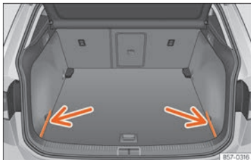
Rys. 167 W bagażniku: osłony do schowania tylnej półki.
