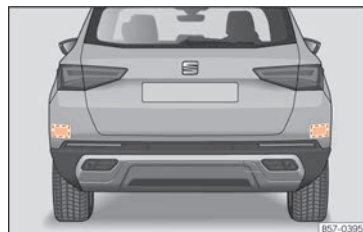
Rys. 111 Widok tylnej części pojazdu: strefy czujników radarowych.
