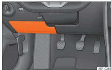
Rys. 197 Na desce rozdzielczej po stronie kierowcy: pokrywa skrzynki bezpieczników.
