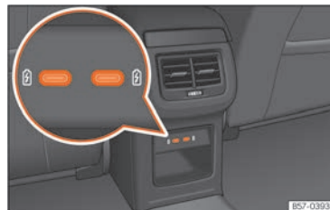
Rys. 157 Tylna konsola środkowa: gniazda USB z funkcją gniazda zasilania.
