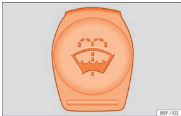
Rys. 208 W komorze silnika: niebieski korek zbiornika płynu do spryskiwaczy szyby przedniej.
