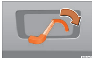
Rys. 64 Bagażnik: zwalnianie ręczne.
