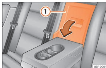
Rys. 176 W oparciu tylnego siedzenia: otwieranie przejścia.
