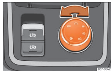
Rys. 105 Konsola środkowa: Przycisk Trybu jazdy.
