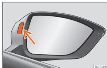
Rys. 128 Lampka kontrolna pojazdu systemu ostrzegania o zjeżdżaniu z pasa ruchu.
