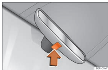
Rys. 89 Lusterko wsteczne ściemnianie ręcznie
