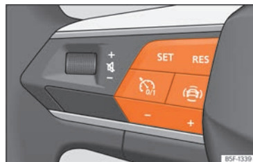
Rys. 115 Na kierownicy wielofunkcyjnej: przyciski do sterowania ogranicznikiem prędkości.
