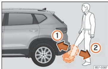
Rys. 62 Klapa bagażnika z otwieraniem sterowanym za pomocą czujnika (Easy Open).
