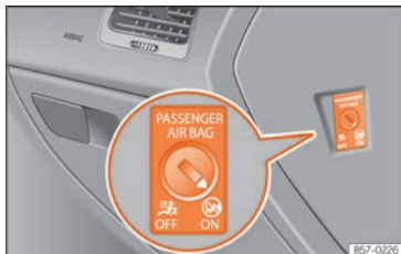
Rys. 29 Przełącznik czołowej poduszki powietrznej pasażera.
