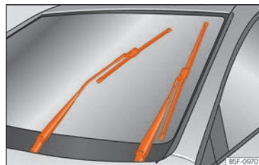
Rys. 188 Wycieraczki w położeniu serwisowym.
