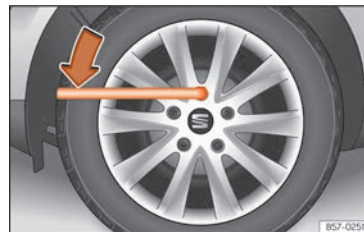
Rys. 222 Wymiana opon: luzowanie śrub koła.
