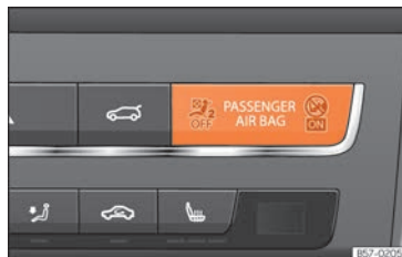
Rys. 30 Deska rozdzielcza: lampka kontrolna dezaktywacji czołowej poduszki powietrznej pasażera na konsoli środkowej.
