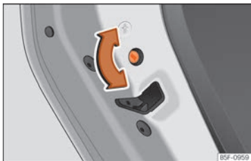
Rys. 58 Blokada przed dziećmi w drzwiach lewych.
