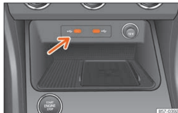
Rys. 156 Konsola środkowa: wejście USB.
