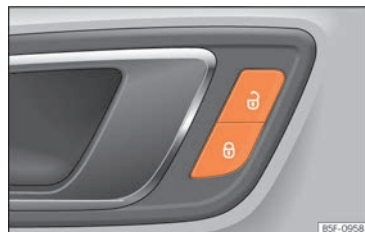
Rys. 54 Na drzwiach kierowcy: przycisk centralnego zamka.
