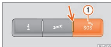
Rys. 45 Na konsoli w podsuftce: sterowanie usługami głosowymi
