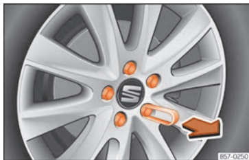
Rys. 220 Koło: śruby kół z nasadkami.
