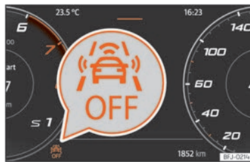
Rys. 123 Wyłączony komunikat Front Assist na ekranie tablicy wskaźników.
