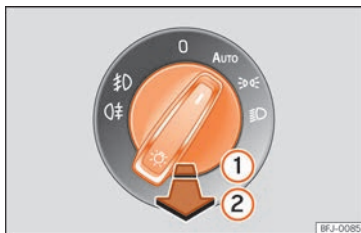
Rys. 83 Tablica przyrządów: przełącznik świateł.
