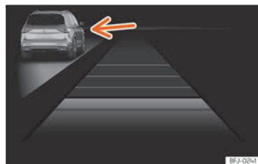
Rys. 118 Na wyświetlaczu tablicy przyrządów: włączony ACC, wykryto pojazd po lewej stronie.
