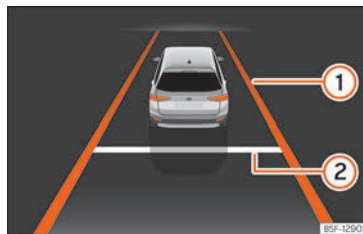
Rys. 125 Na wyświetlaczu zestawu wskaźników: wskazanie aktywnej regulacji (schematycznie).
