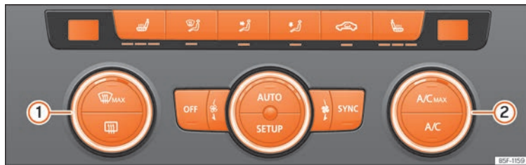
Rys. 92 Na konsoli środkowej: panel sterowania Climatronic.
