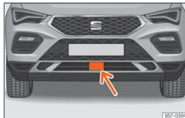
Rys. 108 Na przednim zderzaku: czujnika radarowego.
