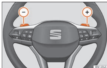
Rys. 103 Kierownica: dźwignia zmiany biegów skrzyni automatycznej
