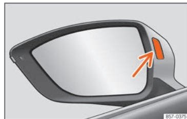
Rys. 127 Lampka kontrolna pojazdu systemu ostrzegania o zjeżdżaniu z pasa ruchu.
