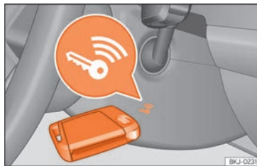
Rys. 98 Po prawej stronie kolumny kierownicy: rozruch awaryjny.
