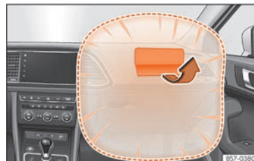
Rys. 28 Czołowa poduszka powietrzna pasażera umieszczona w desce rozdzielczej.
