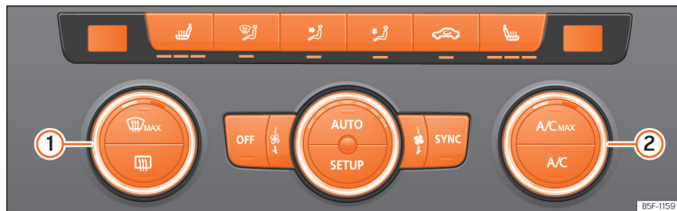
Rys. 92 Na konsoli środkowej: panel sterowania Climatronic.
