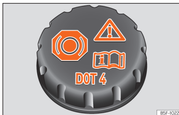
Rys. 208 Komora silnika: korek zbiornika płynu hamulcowego.
