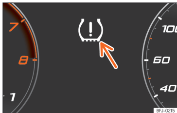
Rys. 227 Tablica przyrządów: ostrzeżenie o spadku ciśnienia w oponach.
