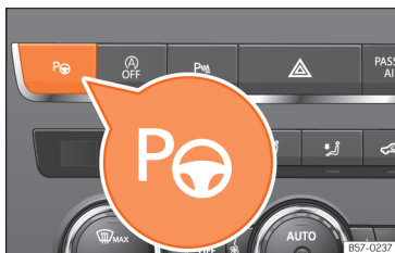
Rys. 138 Górna część konsoli środkowej: przycisk do włączania układu wspomagania parkowania (Park Assist).
