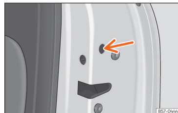
Rys. 57 Ręczne rygłowanie drzwi.
