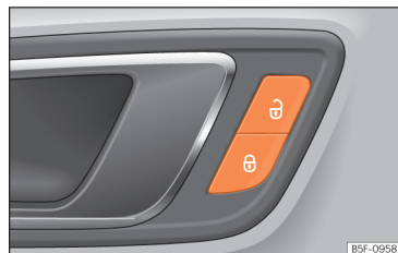
Rys. 54 Na drzwiach kierowcy: przycisk centralnego zamka.
