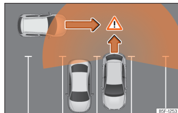
Rys. 151 Schemat asystenta parkowania: wykryty obszar wokół odjeżdżającego pojazdu.
