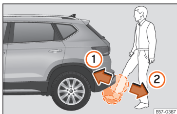
Rys. 62 Kłapa bagażnika z otwieraniem sterowanym czujnikiem (Easy Open).
