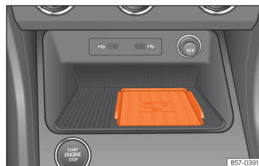
Rys. 165 Konsola środkowa: slot do podłączenia telefonu komórkowego.
