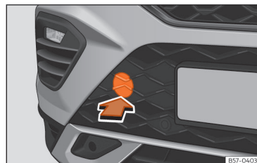
Rys. 194 Zderzak przedni po prawej stronie: zdejmowanie pokrywki.
