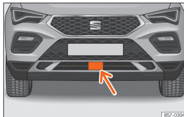
Rys. 108 Na przednim zderzaku: czujnika radarowe.
