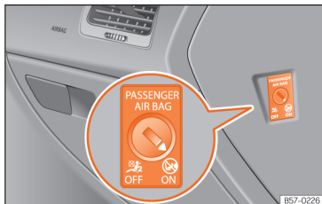
Rys. 29 Przełącznik czołowej poduszki powietrznej pasażera.
