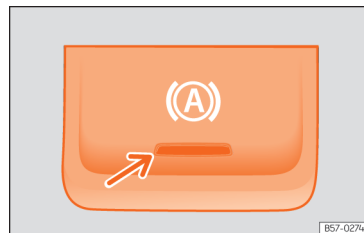
Rys. 132 W dolnej części konsoli środkowej: Przycisk funkcji Auto Hold.
