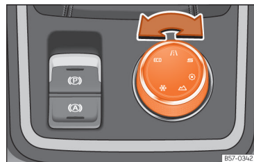
Rys. 105 Konsola środkowa: Przycisk Trybu jazdy.
