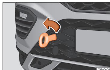
Rys. 195 Prawa strona zderzaka przedniego: dokręcony pierścień holowniczy.
