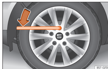
Rys. 223 Wymiana opon: luzowanie śrub koła.
