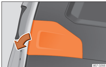
Rys. 202 Otwieranie klapy bagażnika: wyjąć zaślepkę.
