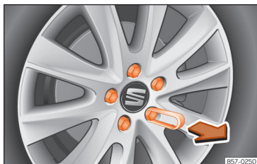
Rys. 221 Koło: śruby kół z nasadkami.
