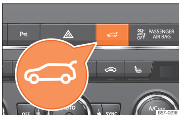
Rys. 61 Konsola środkowa: przycisk otwierania i zamykania klapy bagażnika.
