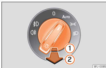
Rys. 83 Tablica przyrządów: przetłącznik światła.
