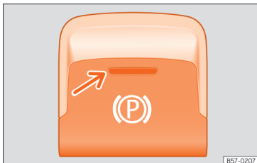
Rys. 131 Dolna część konsoli środkowej: przycisk elektrycznego hamulca postojowego.
