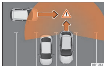
Rys. 154 Schemat asystenta parkowania: wykryty obszar wokół odjeżdżającego pojazdu.
