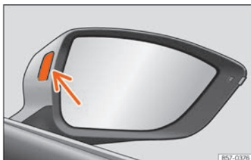
Rys. 131 Lampka kontrolna pojazdu systemu ostrzegania o zjeżdżaniu z pasa ruchu.
