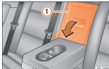
Rys. 180 W oparciu tylnego siedzenia: otwieranie przejścia.
