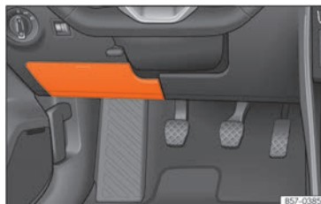
Rys. 201 Na desce rozdzielczej po stronie kierowcy: pokrywa skrzynki bezpieczników.
