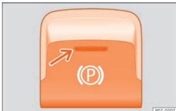
Rys. 134 Dolna część konsoli środkowej: przycisk elektronicznego hamulca postojowego.
