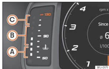
Rys. 8 Cyfrowy zestaw wskaźników SEAT Digital Cockpit: wskaźnik temperatury płynu chłodzącego silnika.
