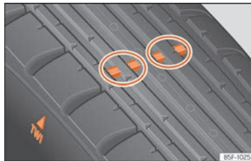
Rys. 219 Profil opony: wskaźniki zużycia bieżnika.
