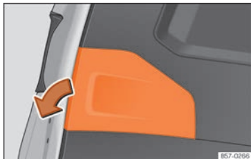
Rys. 205 Otwieranie klapy bagażnika: wyjąć zaślepkę.
