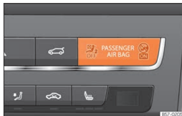
Rys. 30 Deska rozdzielcza: lampka kontrolna wyłączenia czołowej poduszki powietrznej pasażera na konsoli środkowej.
