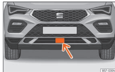
Rys. 108 Na przednim zderzaku: czujnika radarowe.
