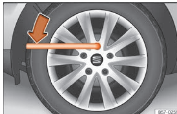
Rys. 226 Wymiana opon: luzowanie śrub koła.
