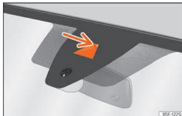
Rys. 110 Na przedniej szybie: pole widzenia kamery Asystenta pasa ruchu.
