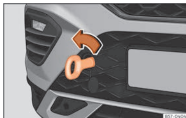
Rys. 198 Prawa strona zderzaka przedniego: dokręcony pierścień holowniczy.
