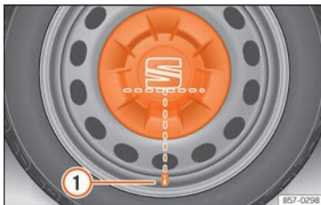
Rys. 223 Prawidłowo założona ostona piasty na feldze stalowej.
