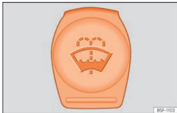
Rys. 212 W komorze silnika: niebieski korek zbiornika płynu do spryskiwaczy szyby przedniej.
