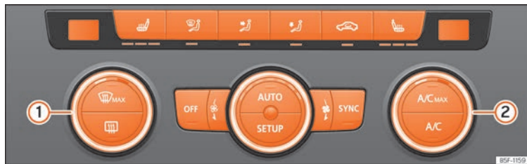
Rys. 92 Na konsoli środkowej: przetłączniki do sterowania klimatyzacją Climatronic.
