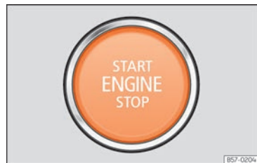
Rys. 97 W dolnej części konsoli środkowej: przycisk rozrusznika.
