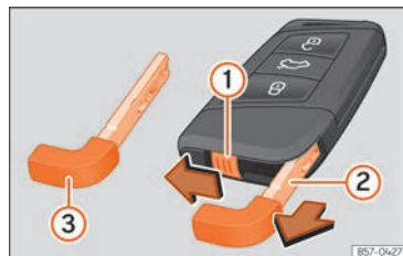
Rys. 48 Kluczyk do pojazdu: wyciągnięcie kluczyka awaryjnego.
