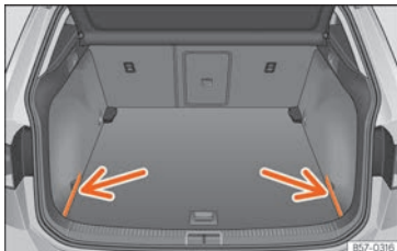
Rys. 171 W bagażniku: osłony do schowania tylnej półki.
