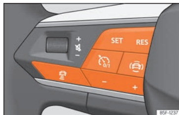
Rys. 118 Na kierownicy wielofunkcyjnej: przyciski do obsługi tempomatu ACC.
