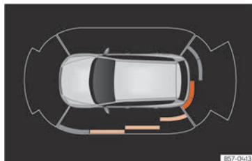
Rys. 139 Widok Asystenta parkowania na ekranie systemu Infotainment.
