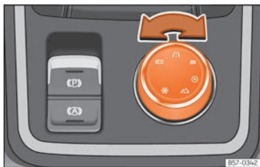
Rys. 105 Konsola środkowa: Przycisk Trybu jazdy.
