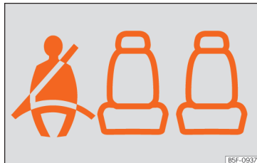
Rys. 20 Zestaw wskaźników: wskazanie stanu pasów bezpieczeństwa tylnych siedzeń.
