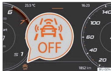
Rys. 126 Wyłączony komunikat Front Assist na ekranie tablicy wskaźników.
