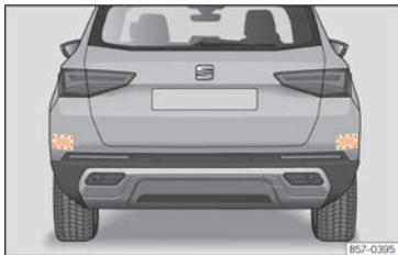
Rys. 111 Widok tylnej części pojazdu: strefy czujników radarowych.
