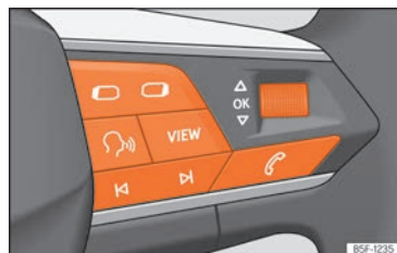
Rys. 12 Prawa strona kierownicy wielofunkcyjnej: przyciski do menu i wskazań informacyjnych na tablicy przyrządów (w zależności od wersji).
