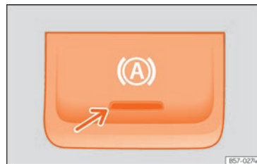
Rys. 135 W dolnej części konsoli środkowej: Przycisk funkcji Auto Hold.
