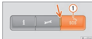
Rys. 45 Na konsoli w podsuftce: sterowanie usługami głosowymi
