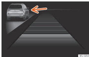
Rys. 119 Na ekranie zestawu wskaźników: włączony ACC, wykryto pojazd po lewej stronie.
