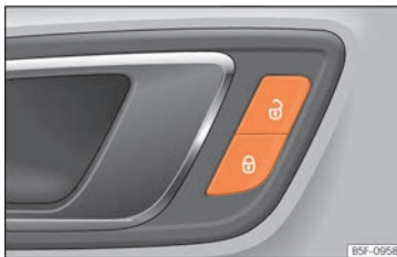
Rys. 54 Na drzwiach kierowcy: przycisk centralnego zamka.
