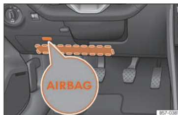
Rys. 34 Po stronie kierowcy: umiejscowienie poduszki powietrznej chroniącej kolana.
