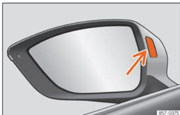
Rys. 130 Lampka kontrolna pojazdu systemu ostrzegania o zjeżdżaniu z pasa ruchu.
