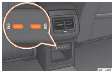
Rys. 161 Tylna konsola środkowa: gniazda USB z funkcją gniazda zasilania.
