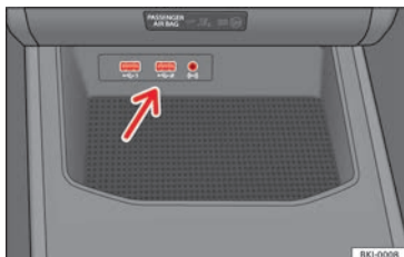
Fig. 111 Centre console: USB/AUX-IN input.
