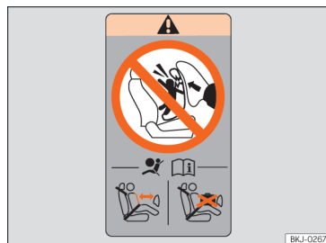
Fig. 3 Targhetta autoadesiva con avvertenze sull'airbag, collocata sul montante B
