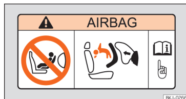
Fig. 2 Targhetta autoadesiva con avvertenze sull'airbag, collocata sull'altina parasole
