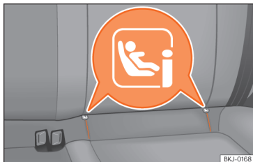
Fig. 4 Contrassegno dei punti di ancoraggio ISOFIX per i seggiolini per bambini
