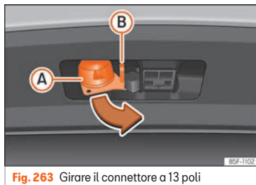
Fig. 263 Girare il connettore a 13 poli
