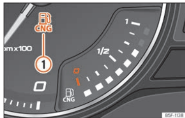
Fig. 122 Quadro strumenti analogico: Indicatore del livello del gas naturale
