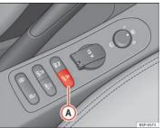
Fig. 119 The Start-Stop function button.
