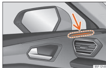
Fig. 194 Door: warning lamp
